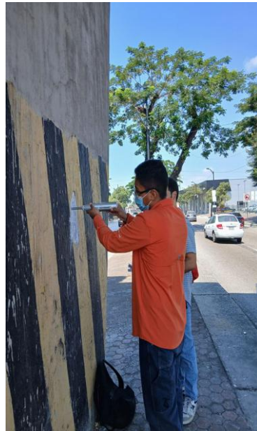
Ilustración 47. Posicionamiento correcto del esclerómetro
