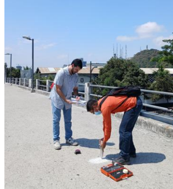
Ilustración 50. Disparo vertical en el tablero del paso peatonal
