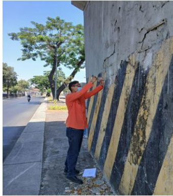
Ilustración 49. Disparo horizontal de esclerómetro
