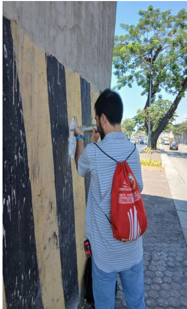
Ilustración 48. Colocación del esclerómetro en el punto
