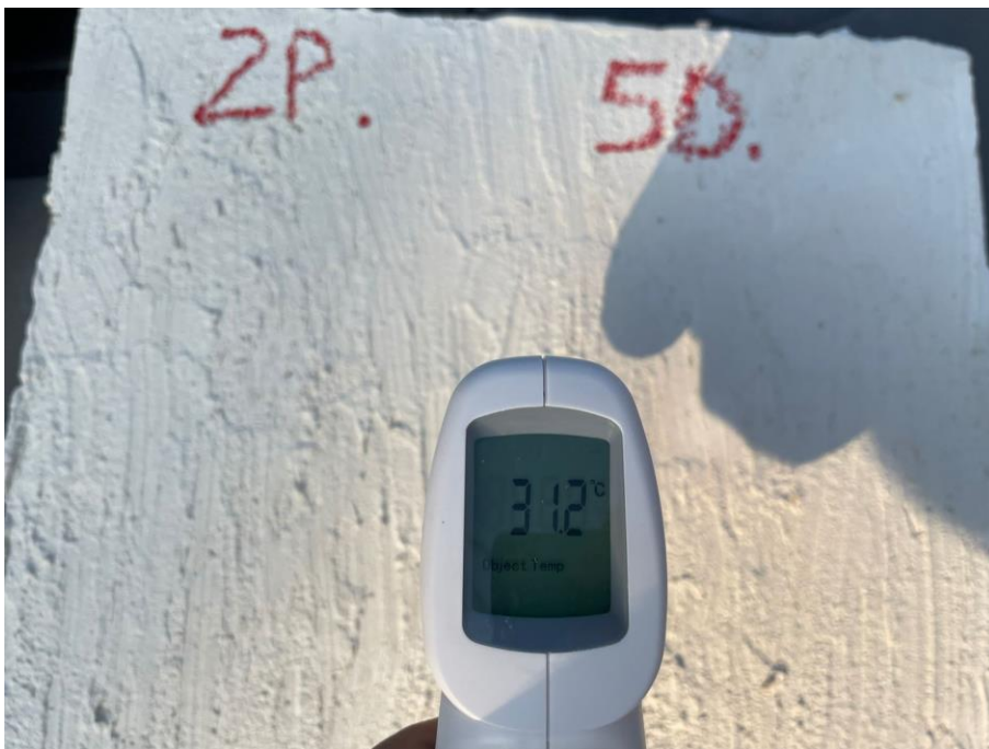
Ilustración 76: Temperatura de 31,2°C en la cara caliente del panel de la dosificación 5.
