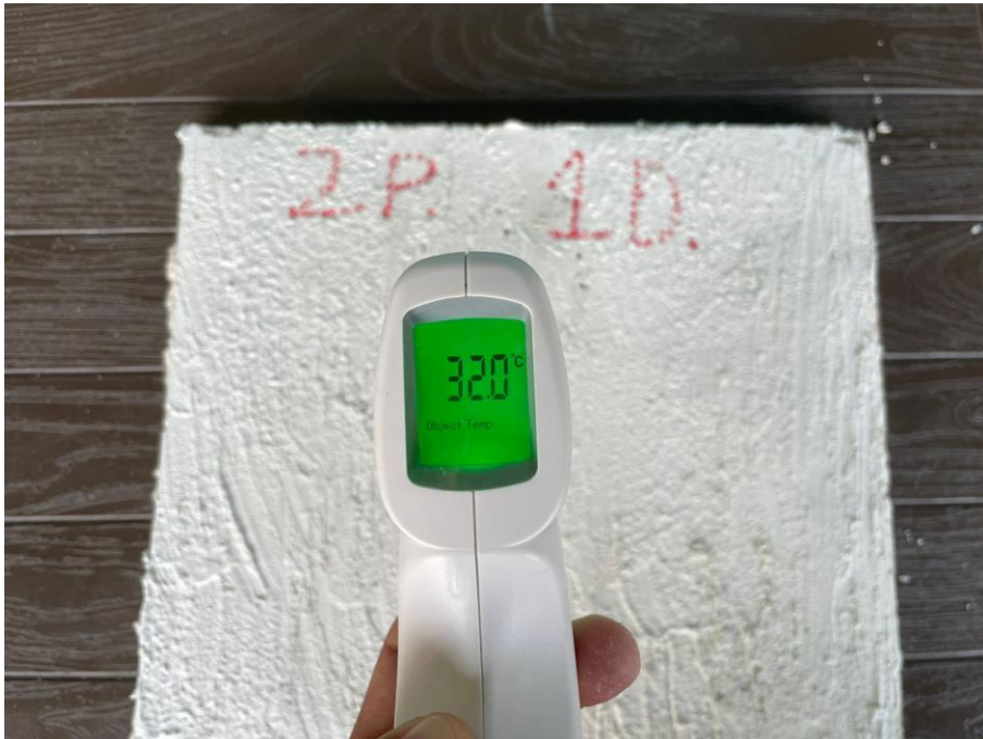
Ilustración 69: Temperatura de 32°C en la cara caliente del panel de la dosificación 1.
