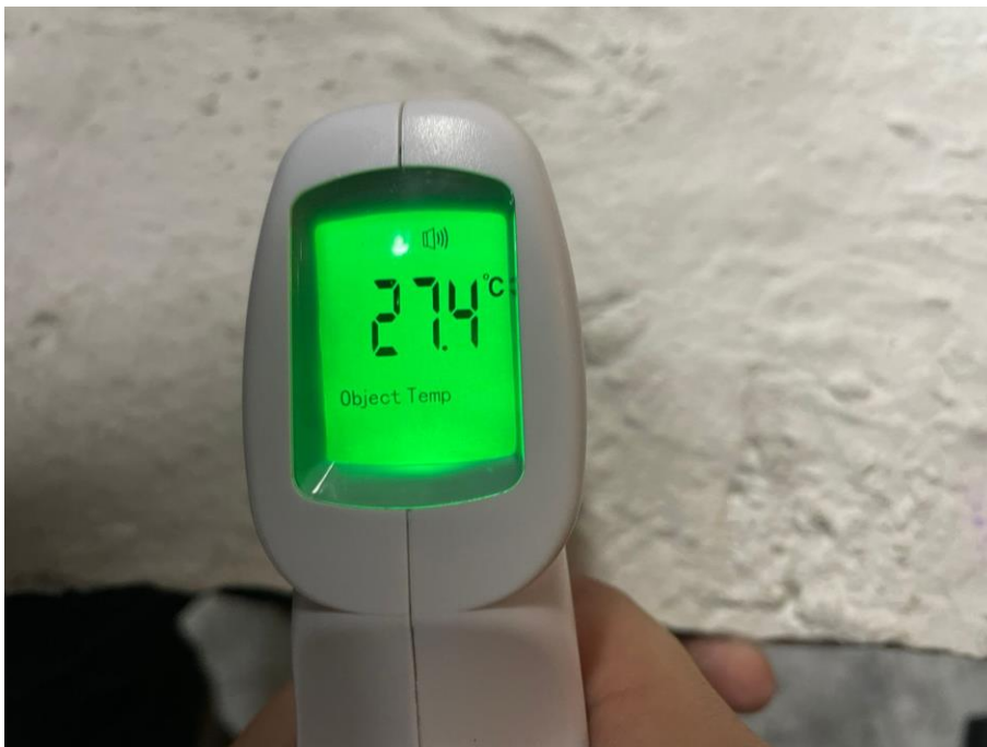
Ilustración 72: Temperatura de 27,4°C en la cara fría del panel de la dosificación 2.
