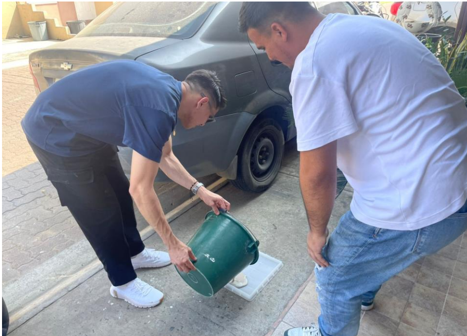
Ilustración 54: Colocación de la mezcla en los moldes.
