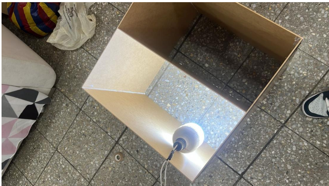
Ilustración 41: Colocación del foco LED en un lado de la caja.
