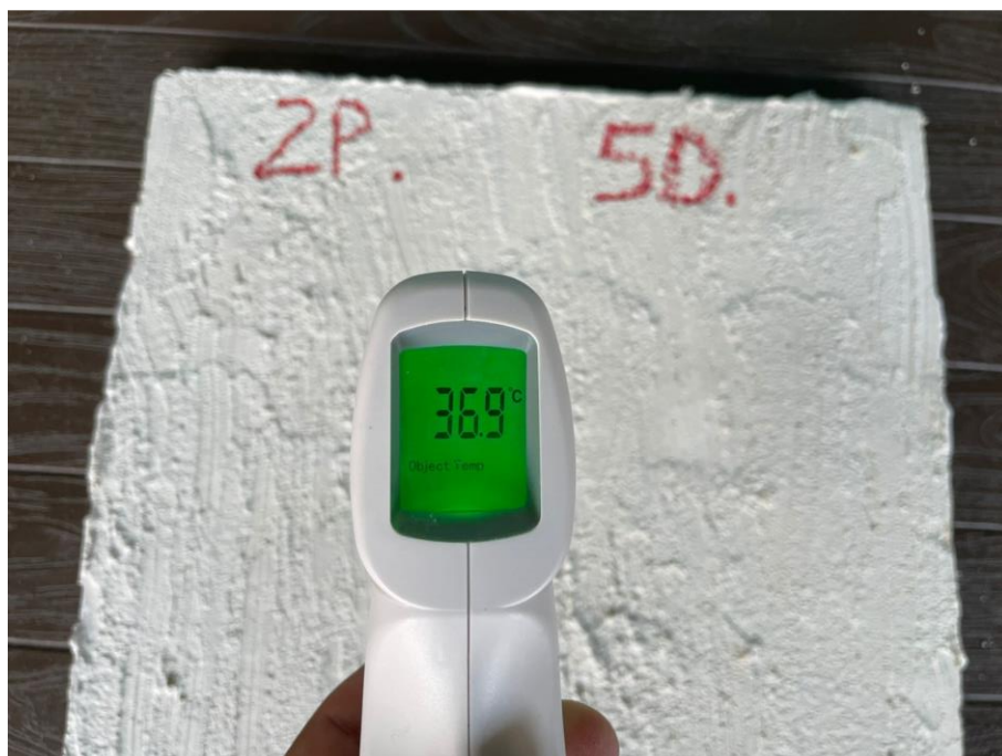
Ilustración 83: Temperatura del segundo panel de la dosificación 5 expuesto al sol.
