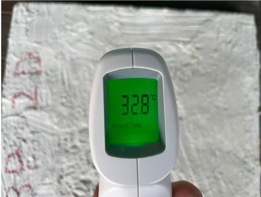
Ilustración 71: Temperatura de 32,8°C en la cara caliente del panel de la dosificación 2.
