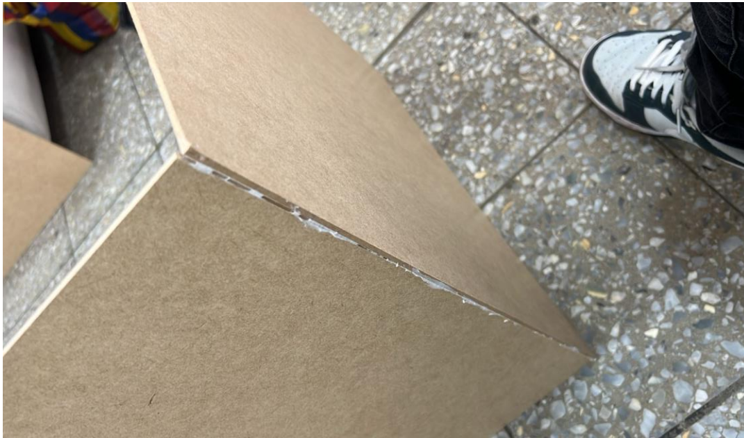
Ilustración 37: Unión de las tablas de madera MDF con la cola blanca.
