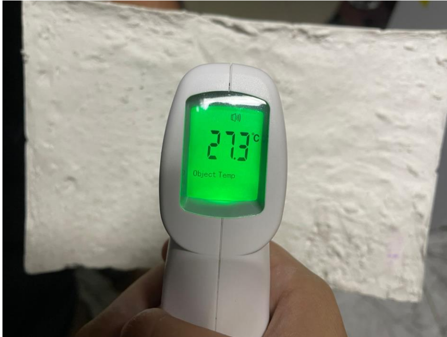
Ilustración 70: Temperatura de 27,3°C en la cara fría del panel de la dosificación 1.
