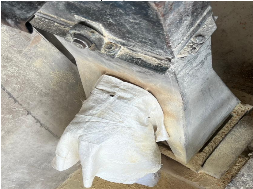
Ilustración 24: Molino de impacto para moler la cáscara de maní.
