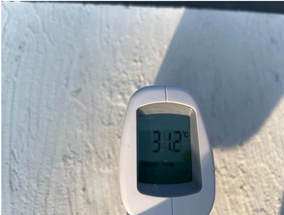
Ilustración 75: Temperatura de 31,2°C en la cara caliente del panel de la dosificación 4.
