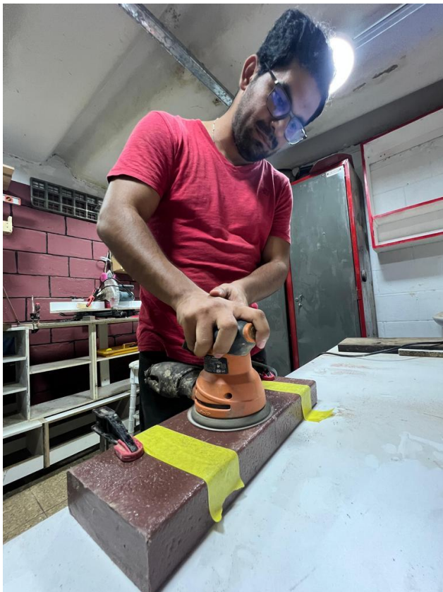
Anexo 10. Prueba de Abrasión (Madera Plástica)
