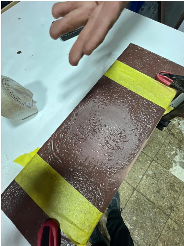
Anexo 11. Resultado de prueba de abrasión (Madera Plástica.)
