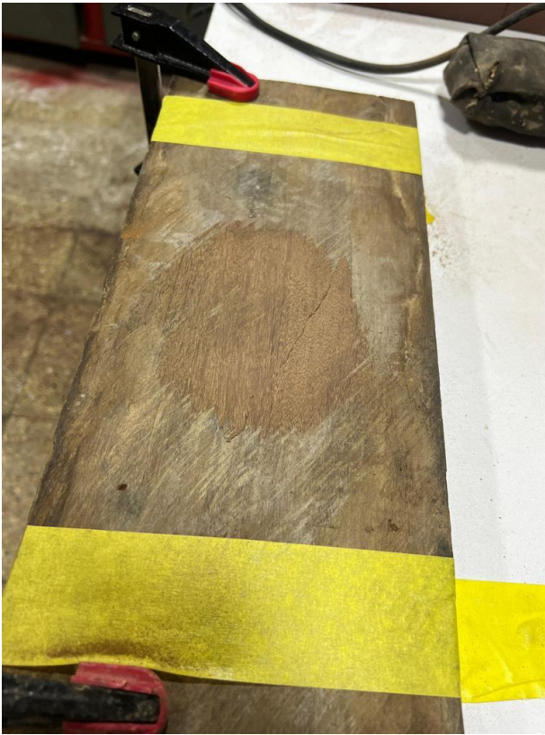
Anexo 9. Resultado de prueba de abrasión (Madera de Chanul.)
