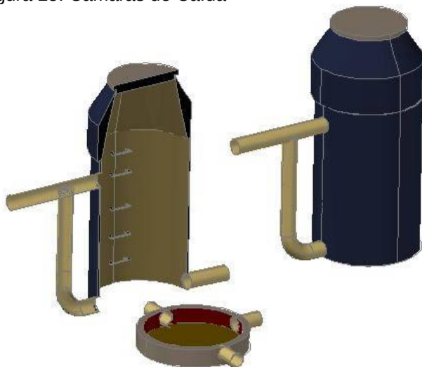
Figura 25: Cámaras de Caída
