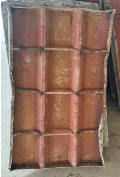
Figura 11. Encofrado de metal después de desencofrar.
