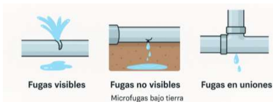
Figura 1. Tipos de fugas en redes de tuberías de agua potable.
