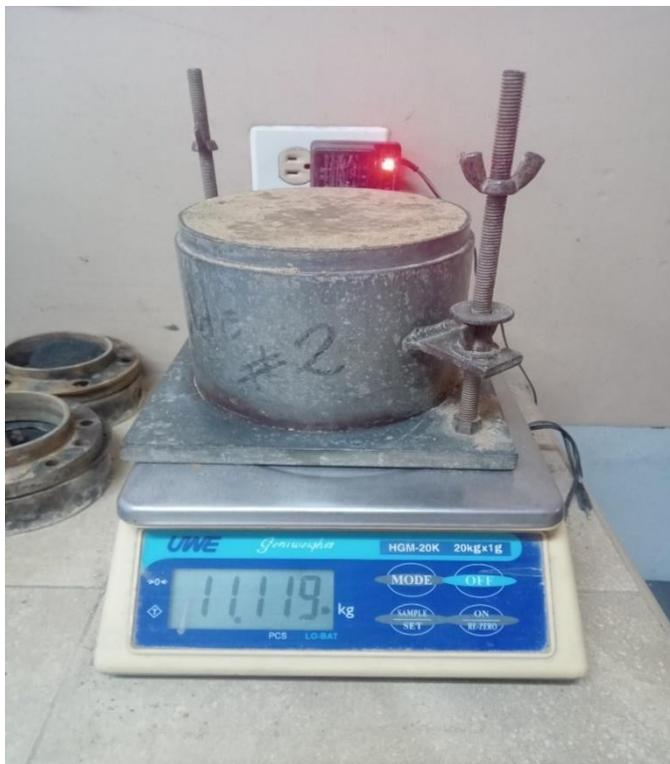
Anexo 39: Ensayo de masa unitaria y varillada asfalto C-1
