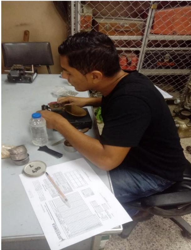
**Anexo 38:** Volumen del material compactado para Ensayo Proctor
