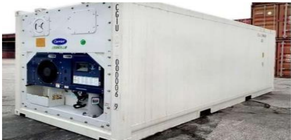
Ilustración 4 Contenedor de Frío Contenedor de Frío 40´ x 8´ x 8´6
