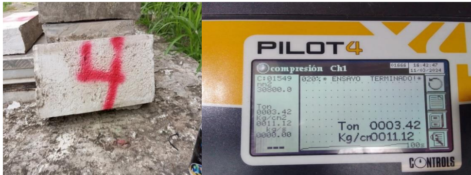
Figura 44: Rotura de muestra No. 4
