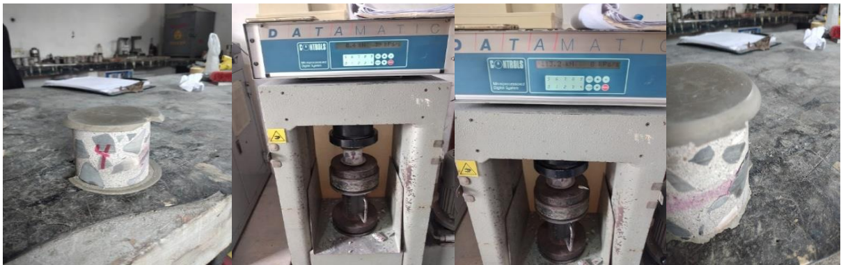
Figura 37: Imágenes Rotura de muestra No 4 de columna del primer piso Imágenes
