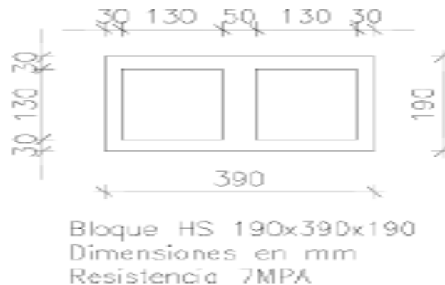
Figura 6: Bloque de hormigón simple.
