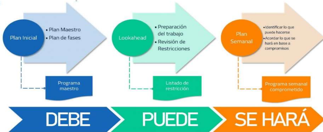
Figura 2 Sistema de Planificación Lean
