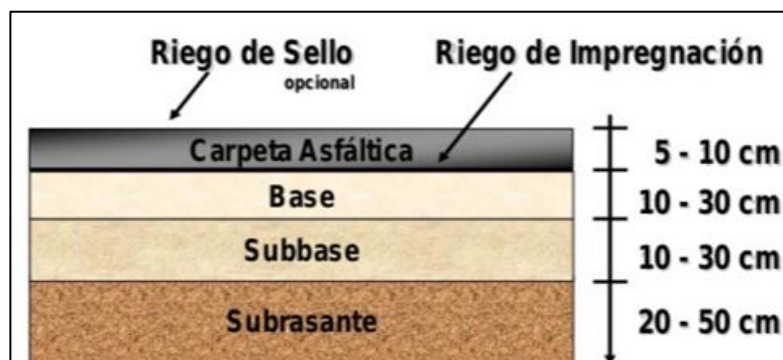
Figura 3: Capas del asfalto
