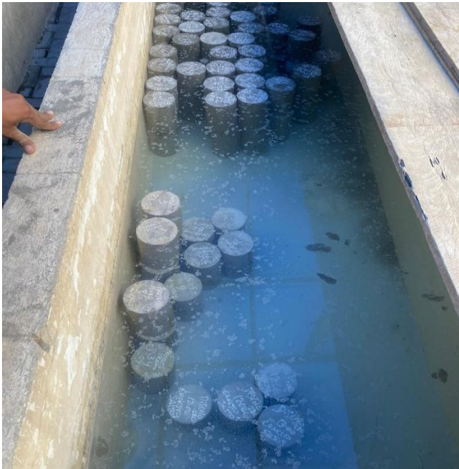
Ilustración 18: Colocación de las muestras en piscina
