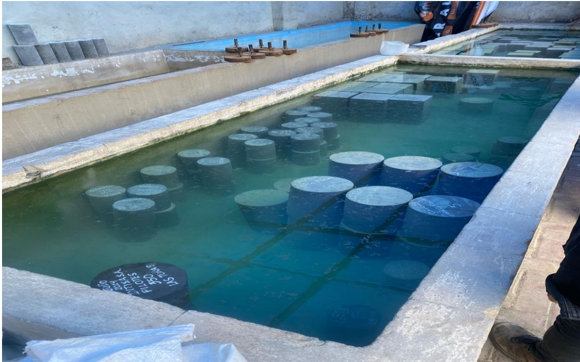
Ilustración 20: Testigo sumergido en una piscina.
