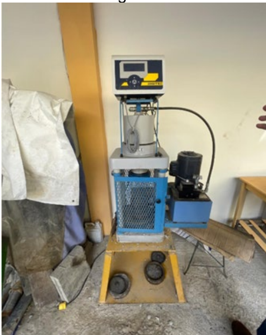
Figura 3 Rotura de hormigón
