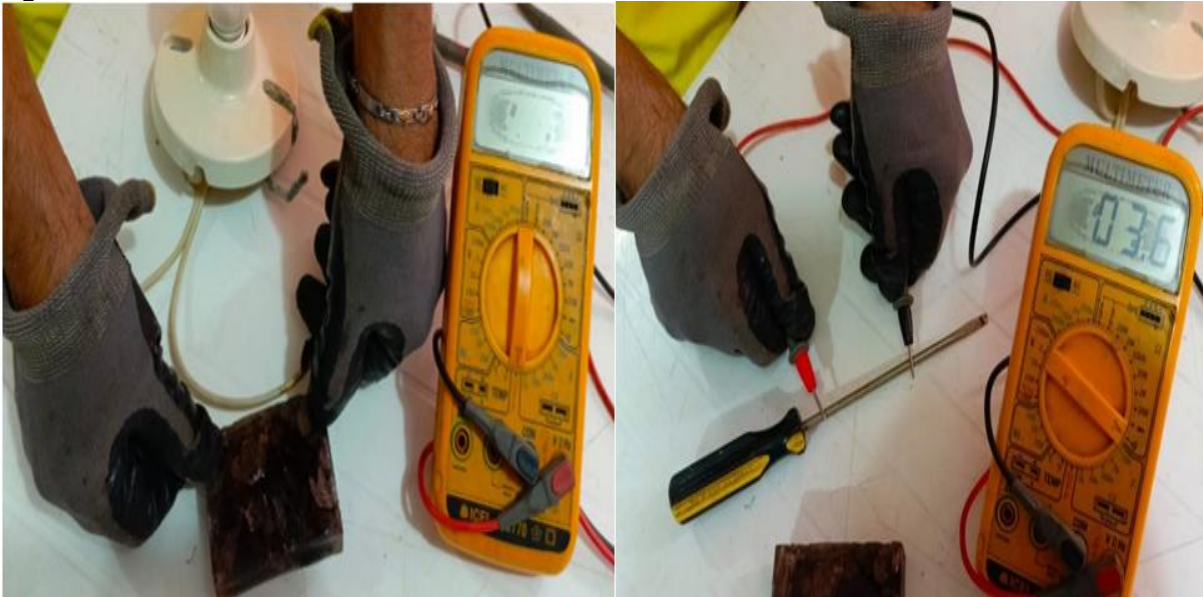
Figura 47. Prueba la Continuidad Eléctrica con Multímetro
