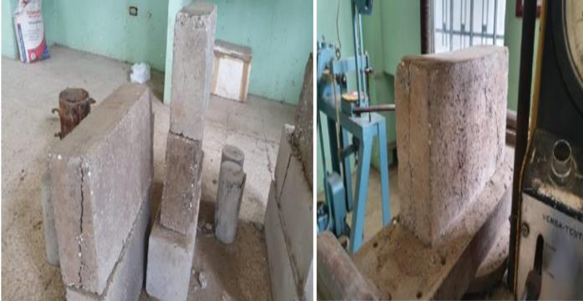
Figura 6. Ruptura del bloque tradicional / Ruptura del bloque alivianado.
