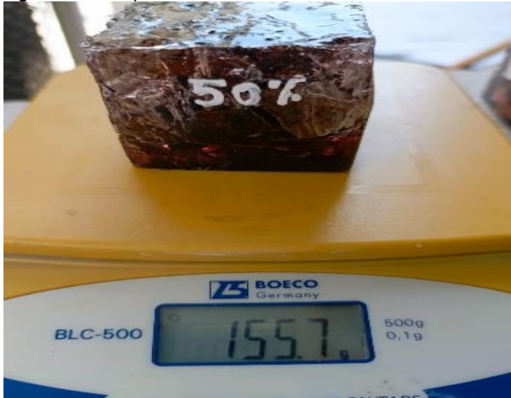
Figura 38. Prototipo 2. Dosificación cacao 50%, resina 50%
