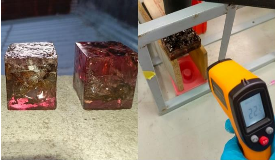
Figura 34. Detalle de las pruebas elaboradas / Prueba Conductividad Térmica
