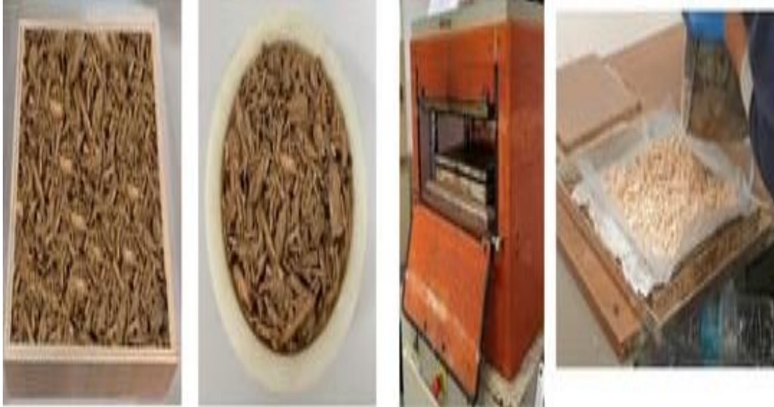
Figura 22. Ensamblaje de los paneles a mano (a) y dispositivo de prensado en caliente (b)
