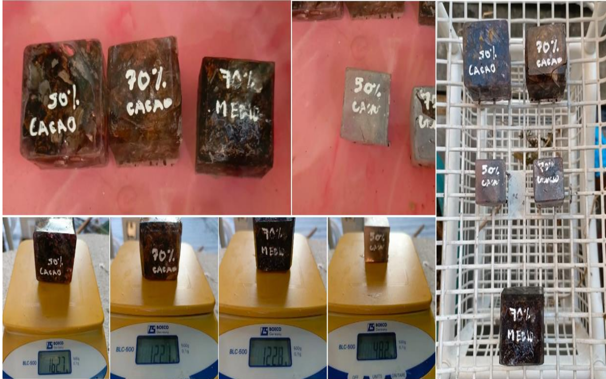
Figura 42. Prototipos en prueba de absorción con peso inicial, secado y peso final.
