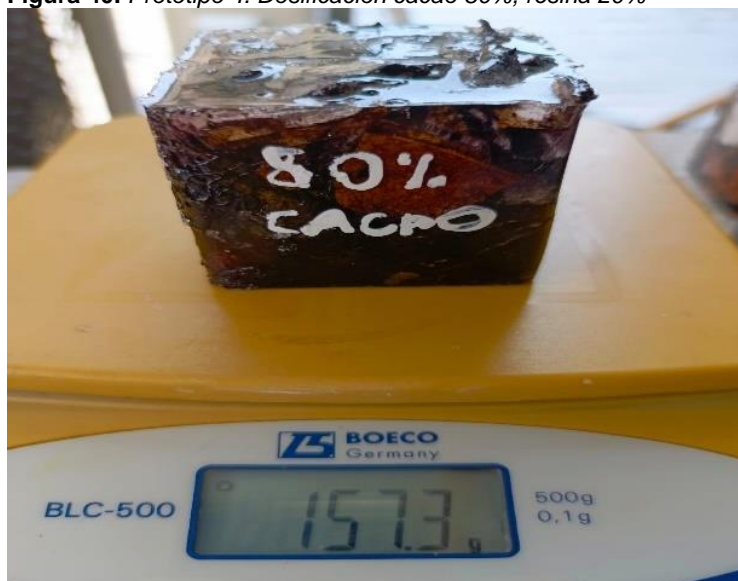
Figura 40. Prototipo 4. Dosificación cacao 80%, resina 20%
