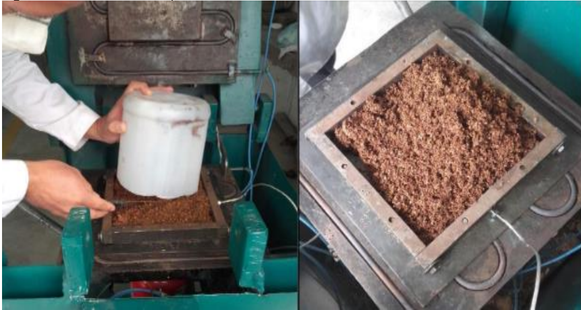
Figura 16. Proceso de llenado para termo conformado.
