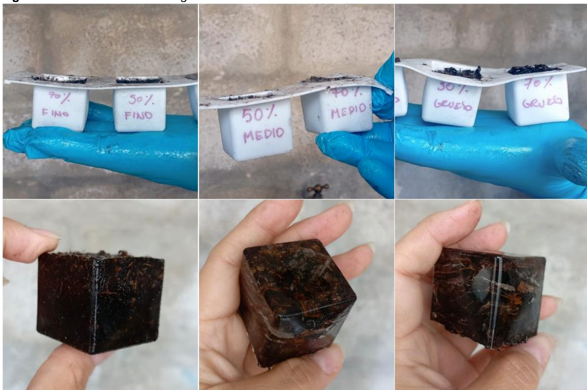
Figura 36. Prueba de diferentes granulometrías de cacao
