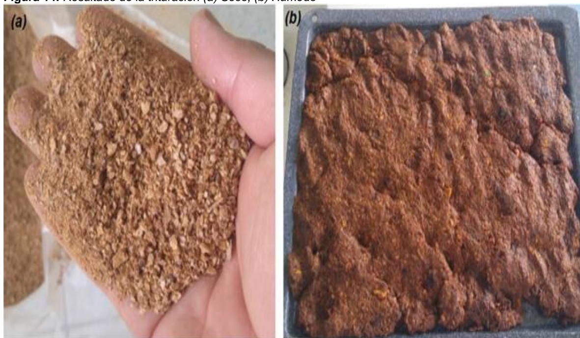
Figura 14. Resultado de la trituración (a) Seco, (b) Húmedo
