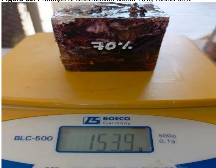
Figura 39. Prototipo 3. Dosificación cacao 70%, resina 30%
