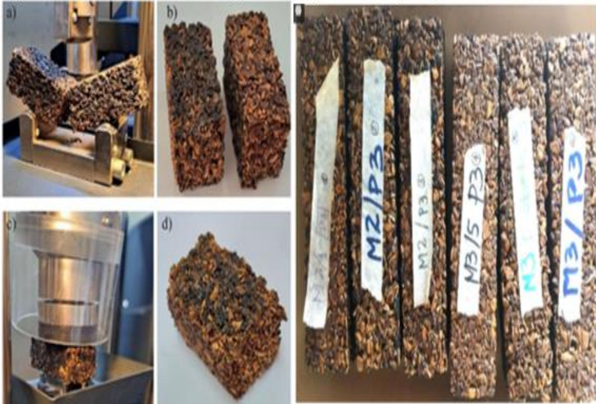
Figura 7. Muestra de aglomerados con CN y muestra ensayada de flexión y compresión.
