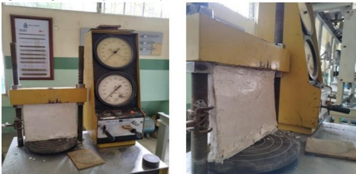
Figura 12. Imagen de los ensayos a flexión compresión
