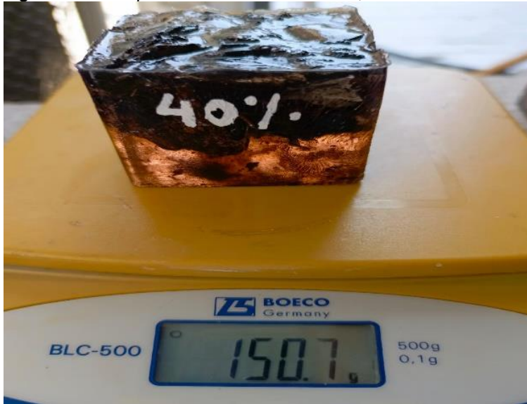
Figura 37. Prototipo 1. Dosificación cacao 40%, resina 60%
