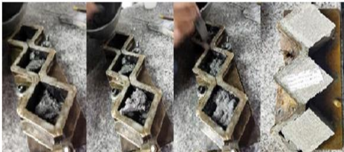
Figura 24. Elaboración de probeta cúbicas de mortero
