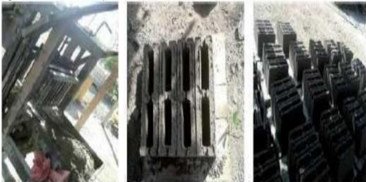
Figura 21. Elaboración de bloques de construcción de cenizas térmicas, cascarilla de arroz
