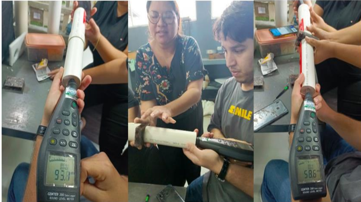
Figura 46. Pruebas de Laboratorio de Conductividad Acústica
