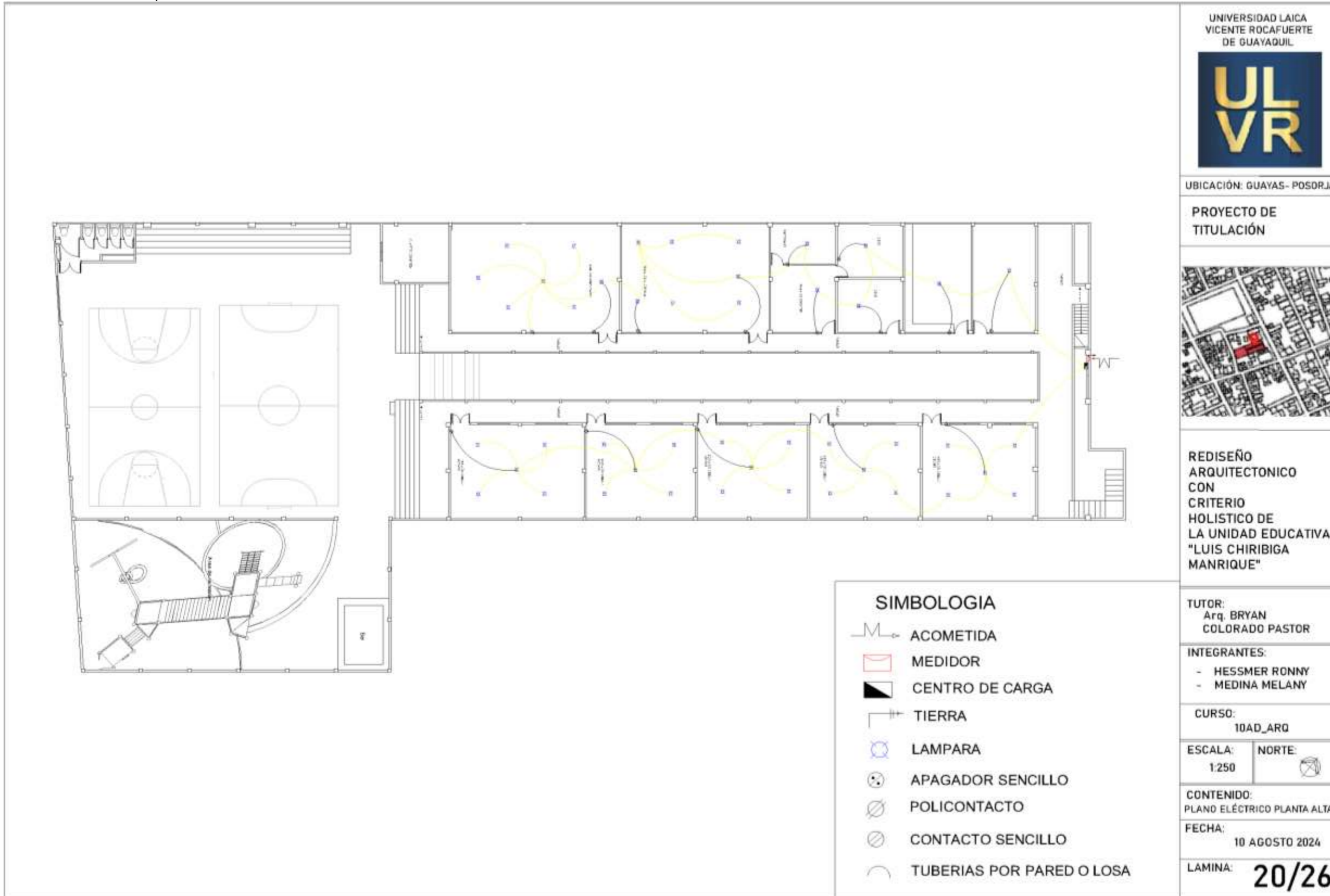
Anexo 20: Plano Eléctrico planta alta
