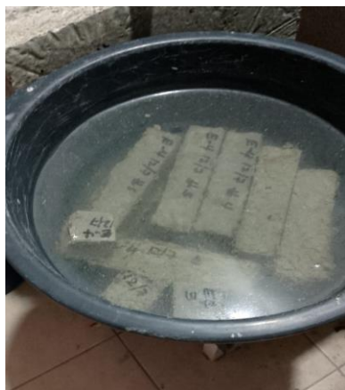
Figura 34. Prueba de humedad
