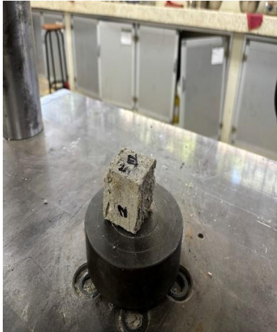
Figura 36. Prueba de compresión
