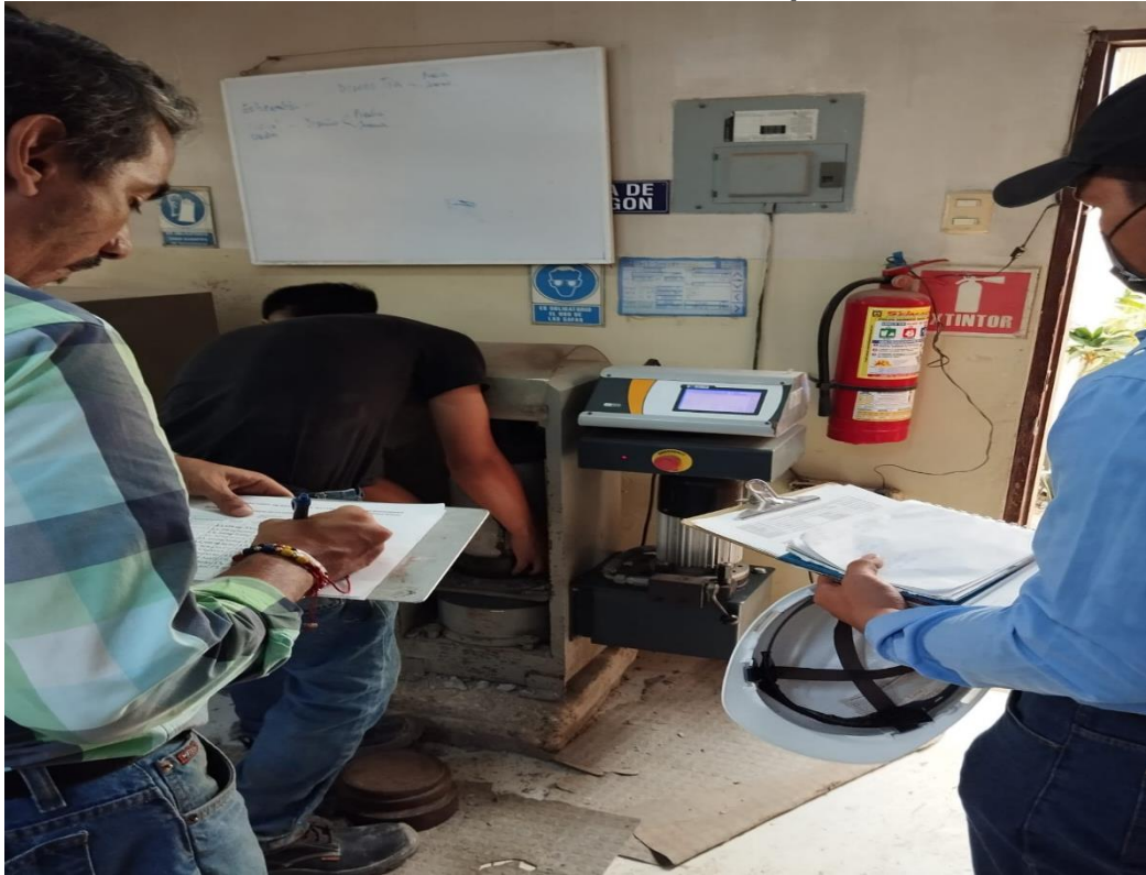
Anexo 11: Rotura de cilindros a compresión a los 7 días
