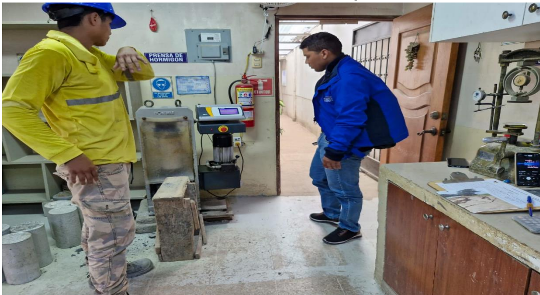
Anexo 12: Rotura de cilindros a compresión a los 28 días
