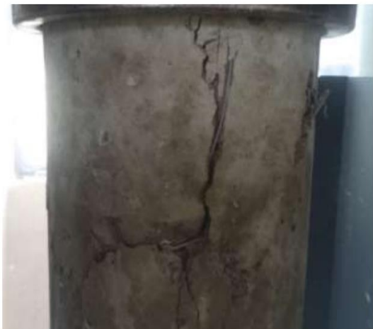
Figura 13. Realización de ensayo a compresión
