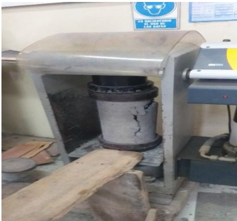
Figura 51. Ensayo a la compresión en cilindros de hormigón con fibras
