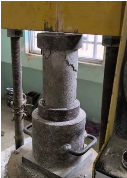
Figura 33: Rotura del cilindro de hormigón sin fibra a los 7 días
