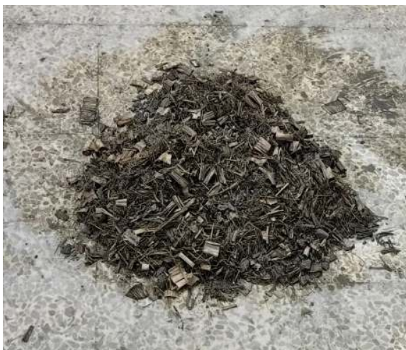
Figura 29: Mezcla sobrante del hormigón con 15% del agregado
