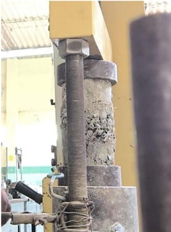
Figura 35: Rotura del cilindro con 5% de fibra a los 7 días
