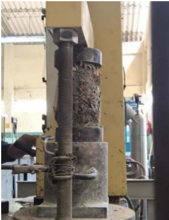
Figura 37: Rotura del cilindro con 10% de fibra a los 7 días
