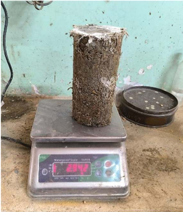
Figura 36: Peso del cilindro de hormigón con 10% de fibra
