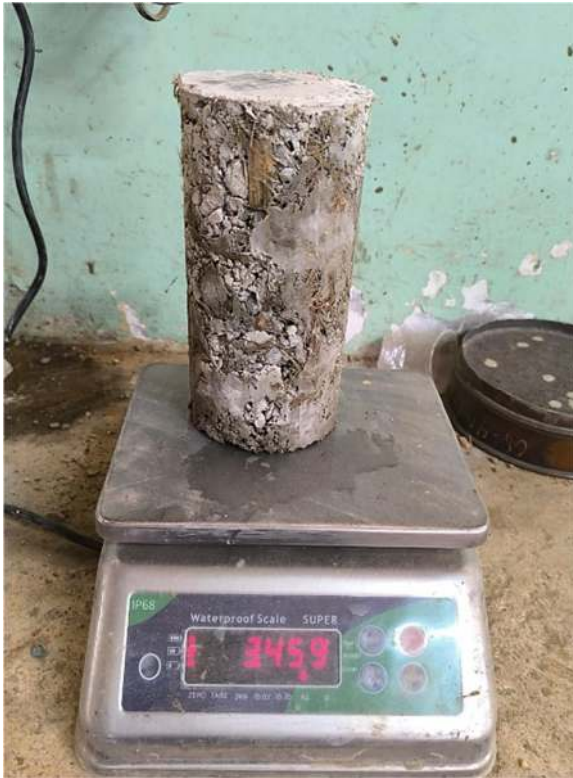
Figura 34: Peso del cilindro de hormigón con 5% de fibra
