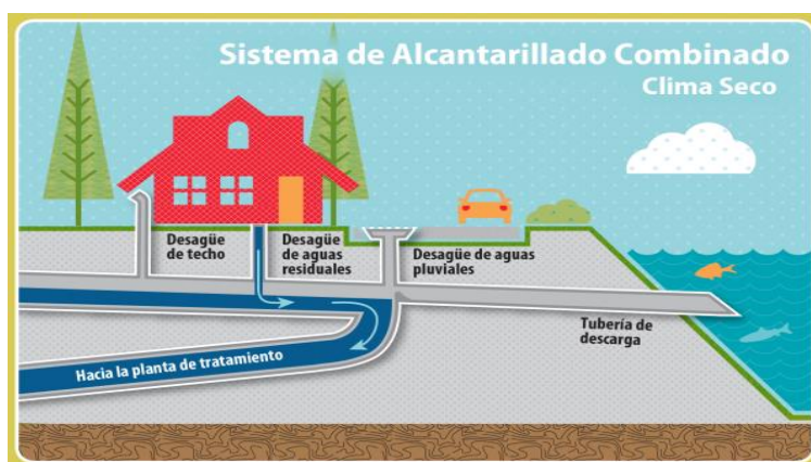
Figura 7 Sistema de alcantarillado combinado
