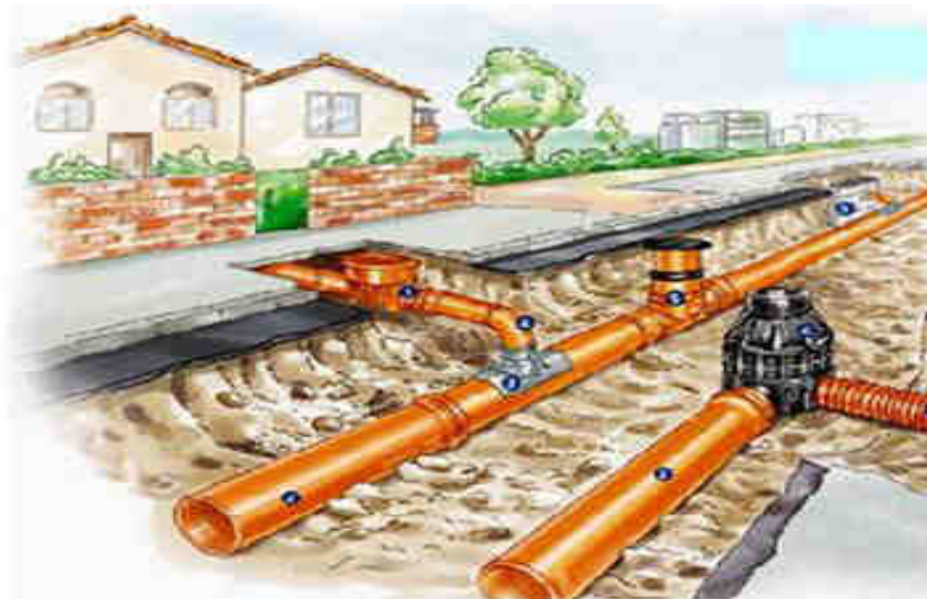
Figura 2 Sistema de drenaje inteligente
