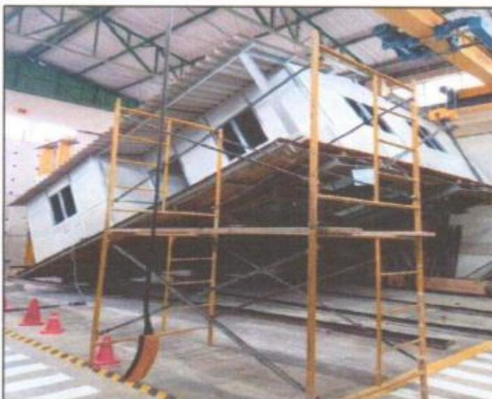
Figura 8. Proceso de ensayo de carga lateral (Inclinación de la vivienda).
