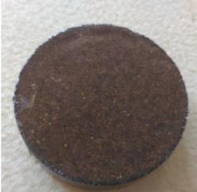
Figura 14 Residuos de hojas de teca/compuesto de poliuretano.
