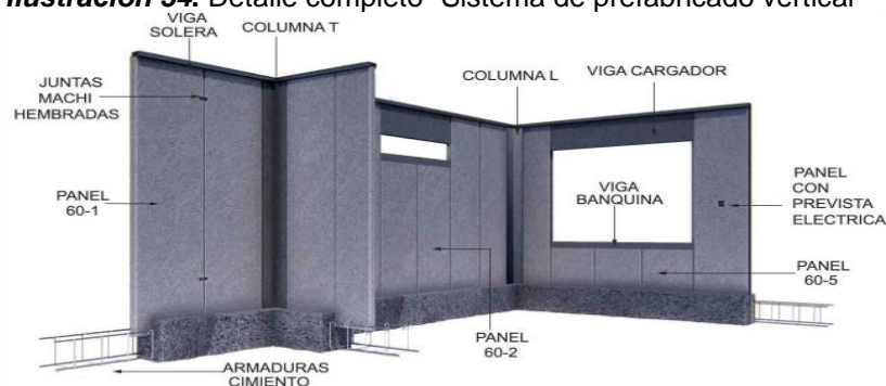
Ilustración 54. Detalle completo- Sistema de prefabricado vertical
