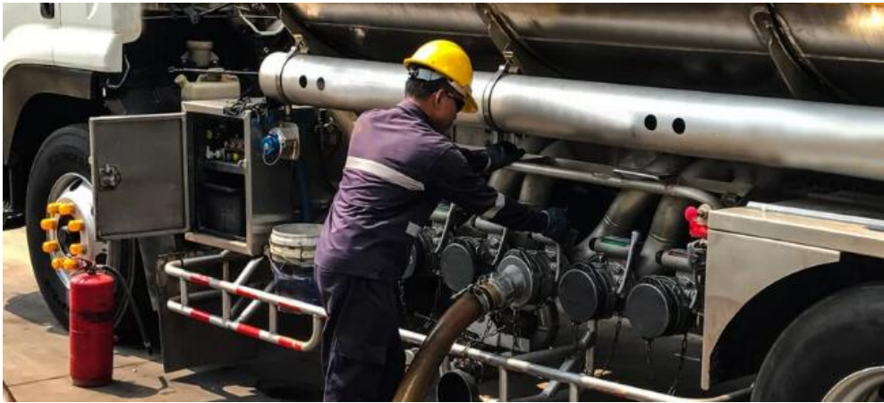
Figura 16 Descarga del combustible
