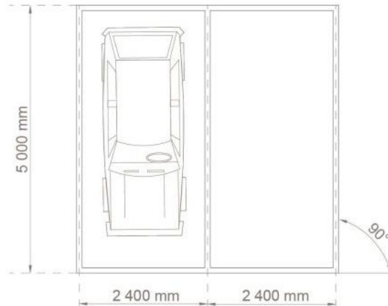
FIGURA 7. Dimensiones mínimas para vehículos tipo N1 y M1
