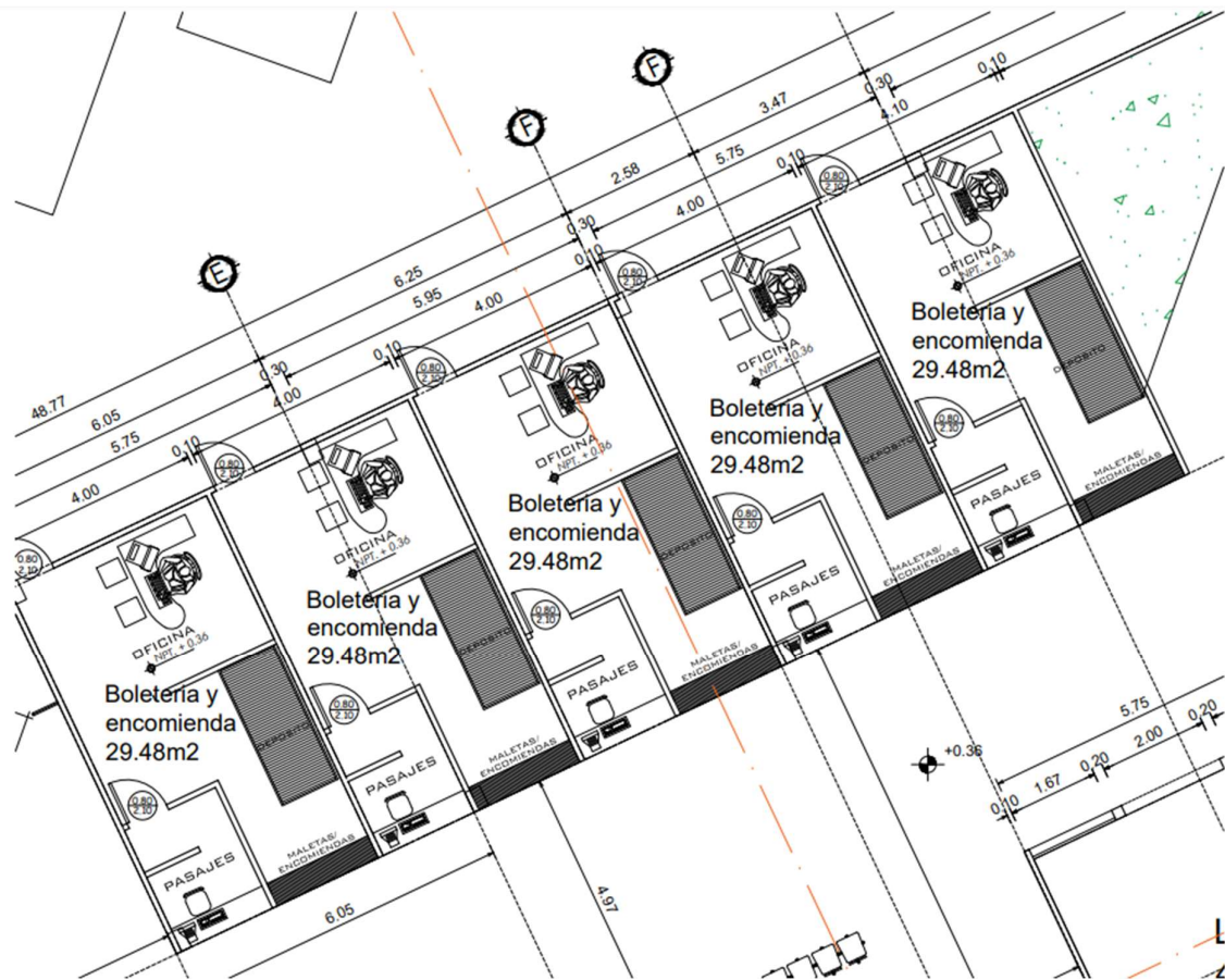
Figura 67 Planta baja, boletería
