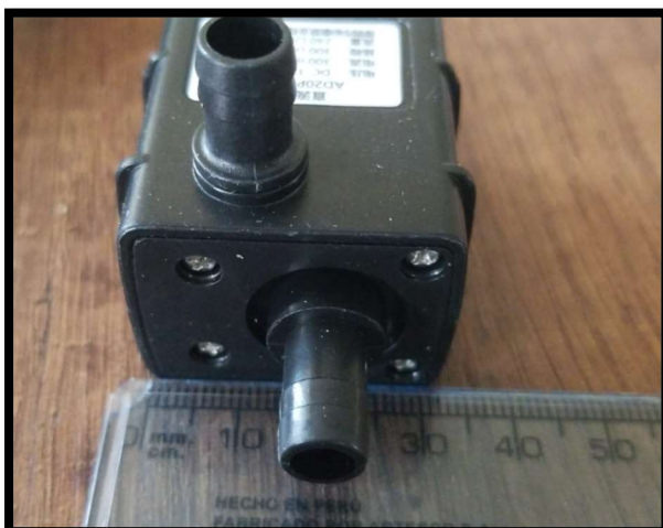
Figura. 18 Bomba para la simulación de filtración en caja de paso
