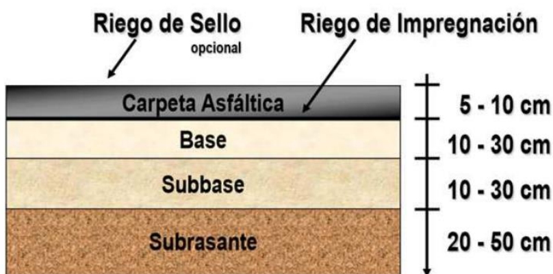
Ilustración 14: Estructura de pavimento flexible.
