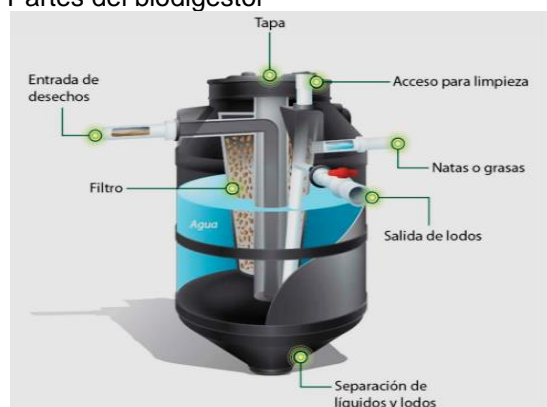
Figura 89 Partes del biodigestor
