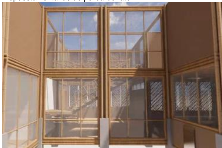
Figura 76 Propuesta ventanas de policarbonato
