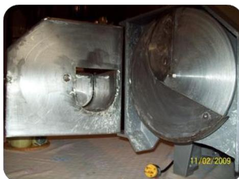
Fabricación en acero inoxidable para alimentos y fundiciones de Aluminio, cuchillas curvas en acero, con regulación de corte de 1 a 4 mm, tapa abisagrada para fácil limpieza, boca y canal de Alimentación con empujador para varias papas o plátanos, construida sobre base de aluminio, motor de 1/2 hp, 1730 rpm, 110 Voltios, construida sobre base en aluminio fundido. Peso: 25K, Dimensiones 60 x 40 x 50 cm de alto.
