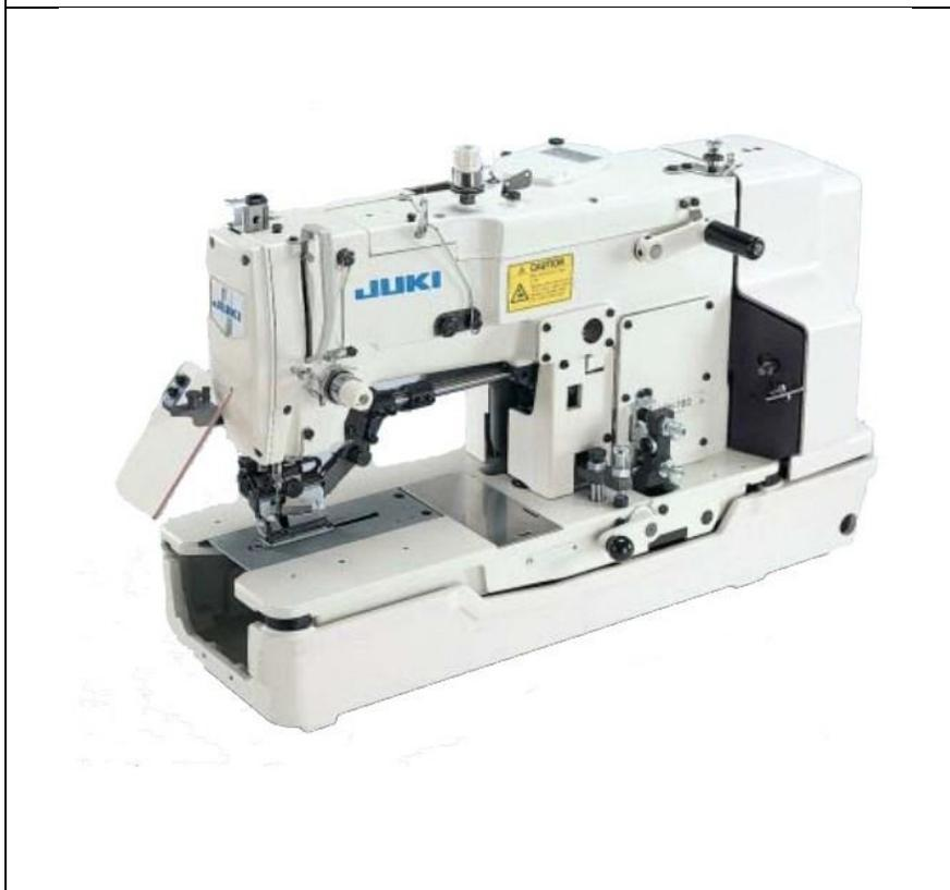
Esta máquina es utilizada para realizar los ojales en camisas y camisetas siendo esta de una manera 10 veces mayor a realizar con una maquina pequeña de forma manual y al final del proceso deja abierto el ojal.
