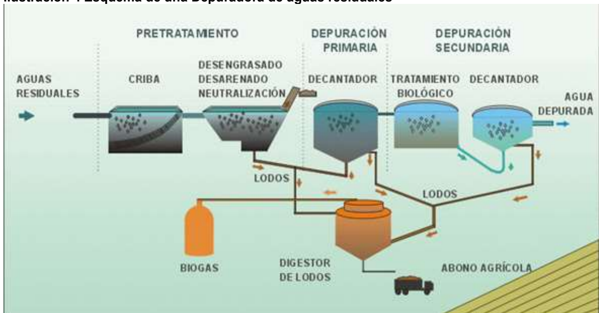
Ilustración 4 Esquema de una Depuradora de aguas residuales
