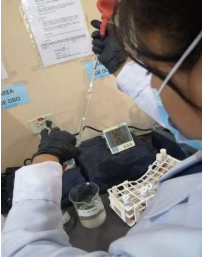
Ilustración 28 Adición del floculante a la muestra
