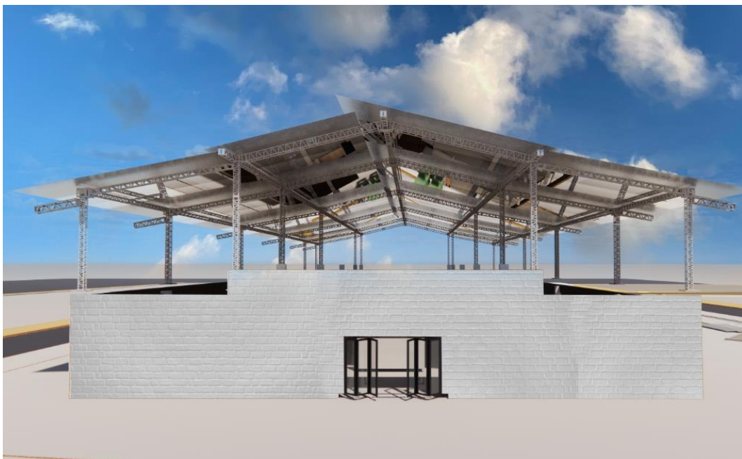
Figura 177. Ladrillo hueco y plancha tipo sándwich revestidas de aluminio.
