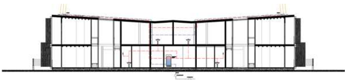
Figura 185. Sistema de calentamiento de agua a través de paneles solares
