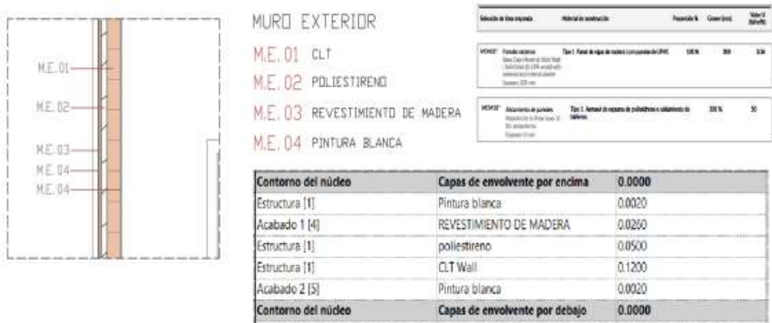
Figura 172. Detalle de muro exterior
