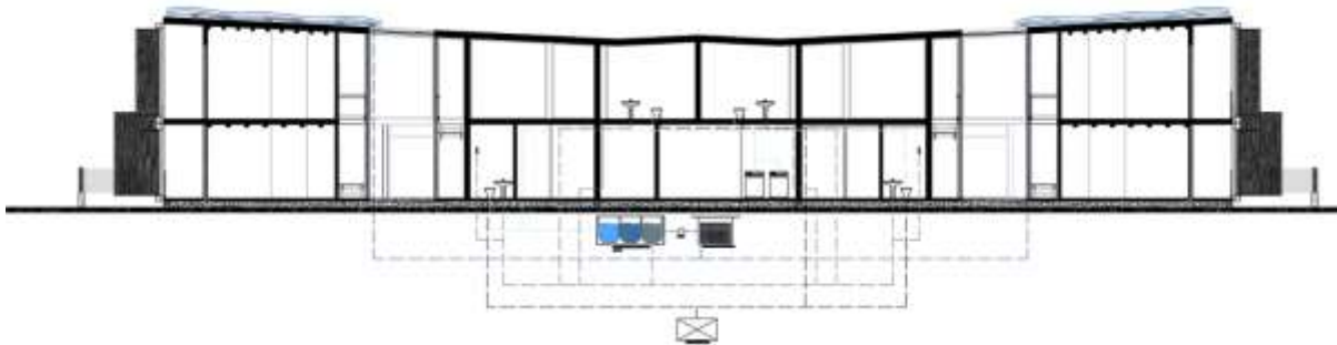
Figura 168. Sistema de captación y tratamiento de aguas
