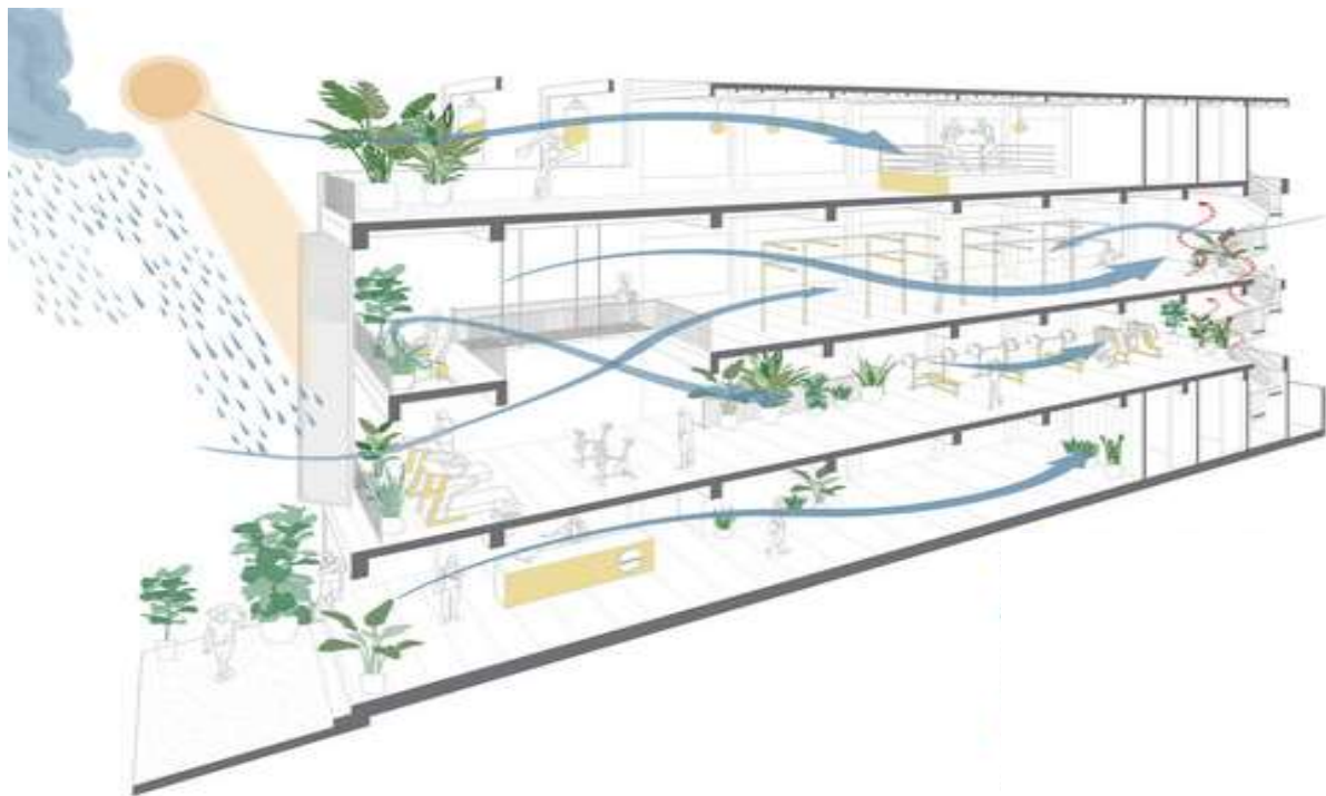
Figura 20. Edificación con ventilación cruzada
