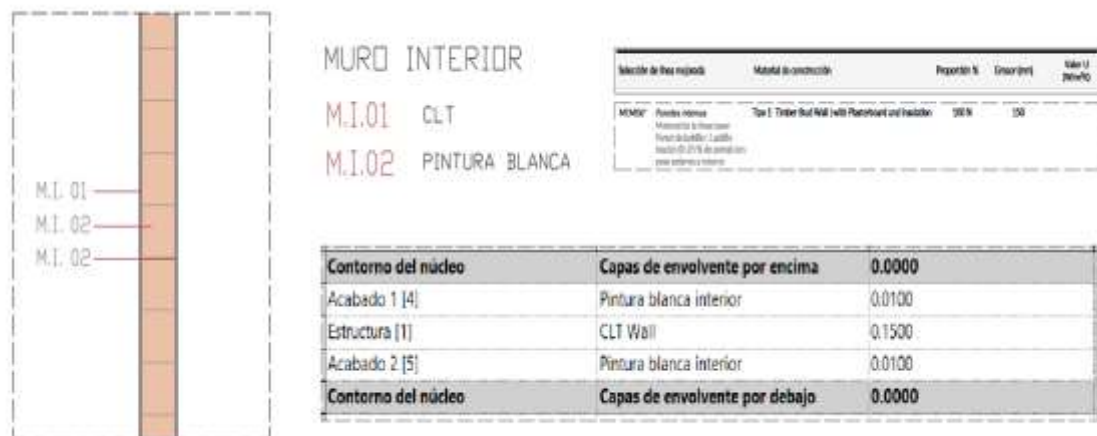
Figura 173. Detalle de muro interno
