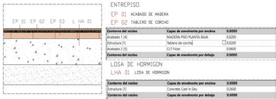
Figura 170. Detalle de losa
