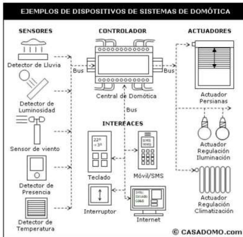
Figura 6. Ejemplos de dispositivos de domótica
