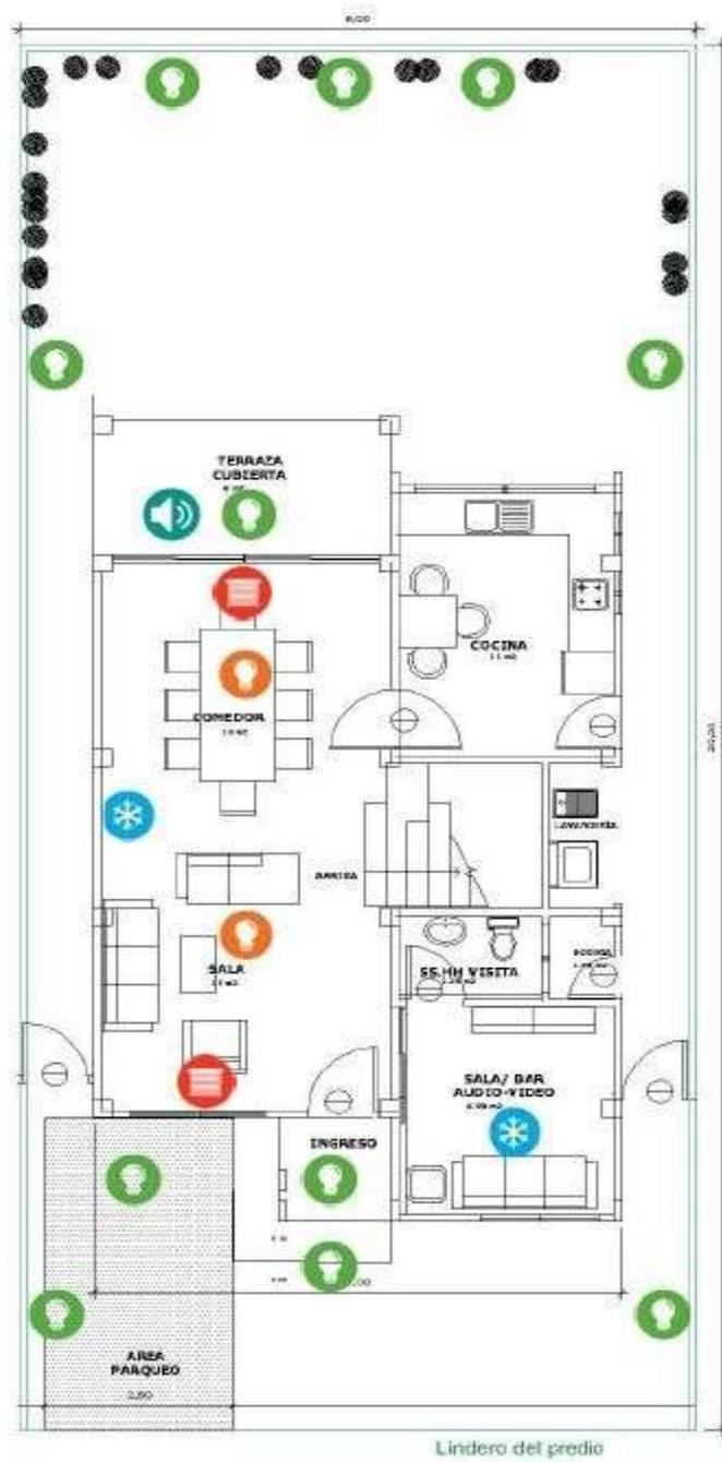
Figura 24. Diseño del Sistema de domótica a implementar en planta baja de una vivienda
