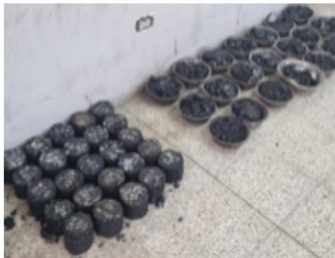
*Nota.* En la margen izquierda de la figura se muestran las briquetas y en la margen derecha las muestras para la determinación de porcentajes de vacíos.
