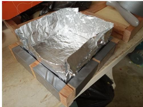
*Figura 42: Molde cubierto de papel aluminio*
