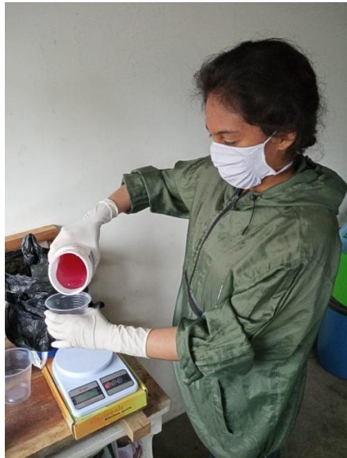
*Figura 59: Pesaje de la resina de poliéster*
