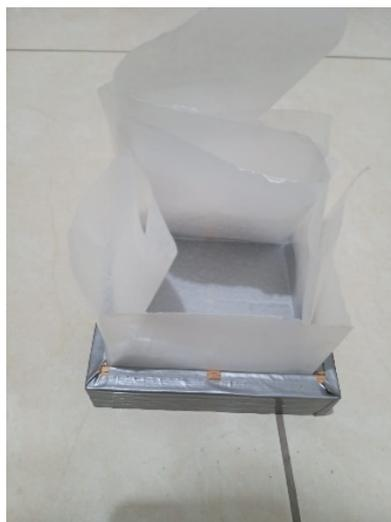
*Figura 43: Molde cubierto de papel encerado*
