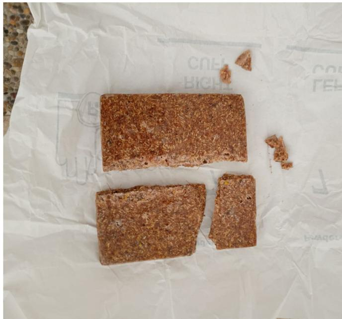
*Figura 72: Prototipo PFCYCA 04 después de la prueba de rotura vertical*
