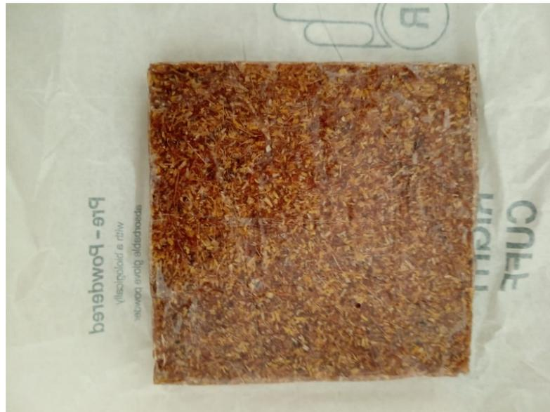
*Figura 68: Prototipo PFCYCA 04 después de prueba de compresión*
