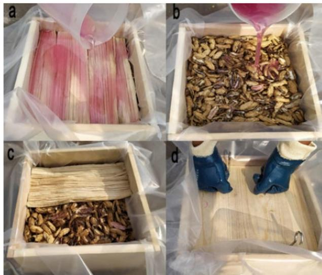
*Figura 7: Proceso prototipo panel de cáscara de maní y fibra de plátano.*
