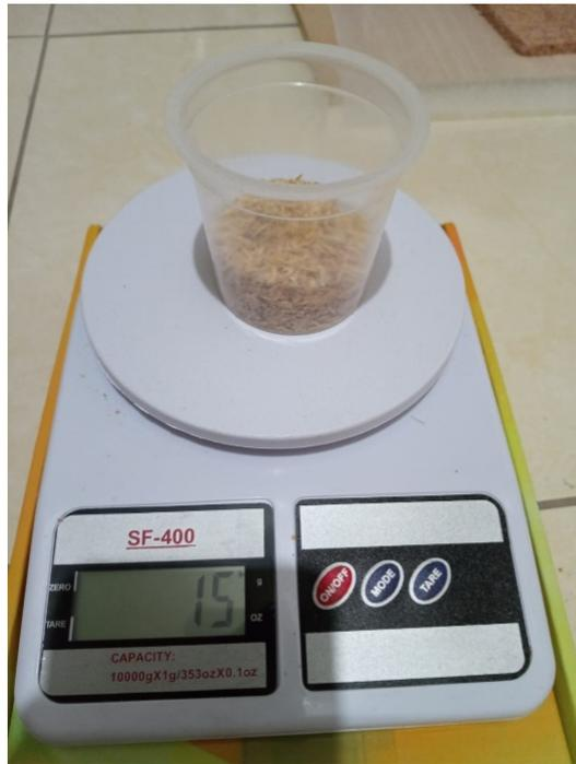
*Figura 47: Pesaje de cascarilla del arroz*
