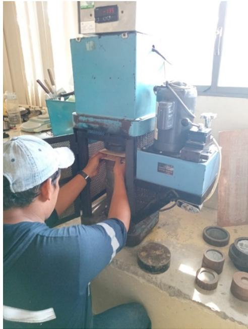
*Figura 65: Prueba de compresión*
