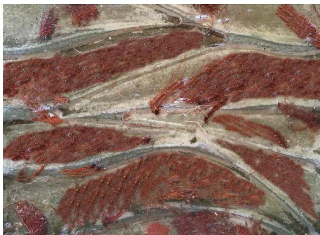
*Figura 4: Prototipo panel a base de fibra de vidrio y estopa de coco.*
