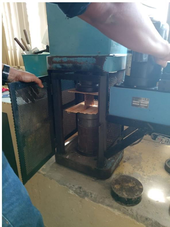
*Figura 70: Prueba de compresión rotura vertical*
