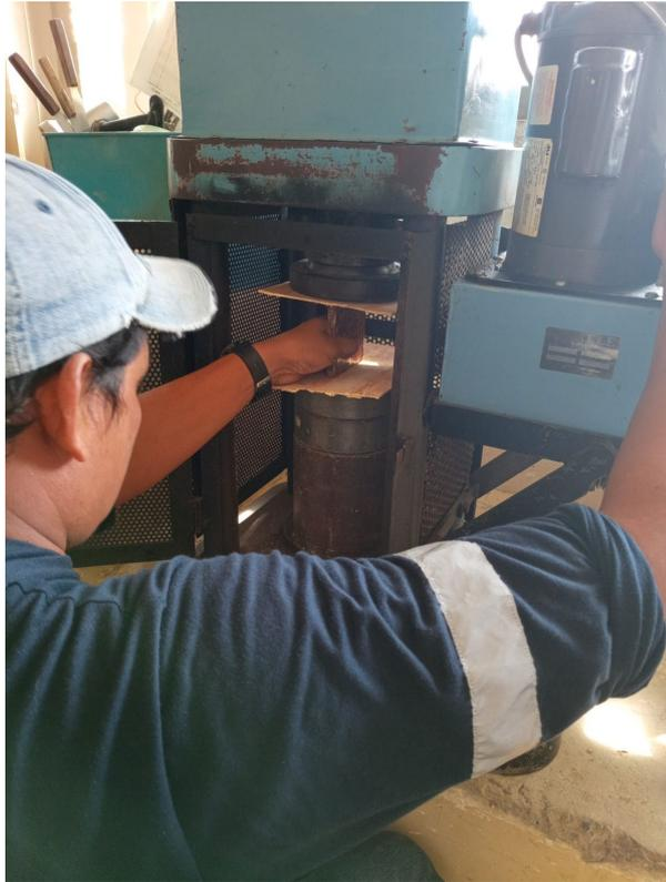
*Figura 69: Prueba de compresión*
