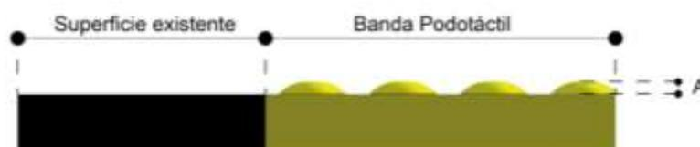
*Ilustración 34 Colocación a nivel de piso terminado
