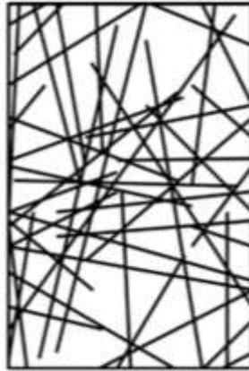
*Ilustración 27 Patrón geométrico utilizado por Arnold Glass para la distribución de la tinta reflectora de luz ultravioleta*
