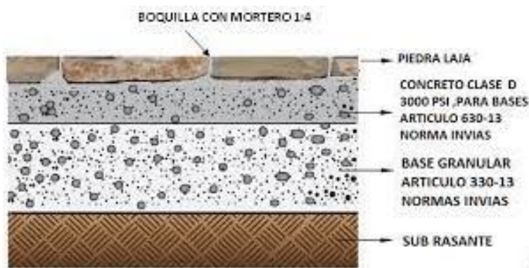
Figura 85: Proceso constructivo pavimento en piedra. Fuente: Universidad Católica de Colombia, 2015.
