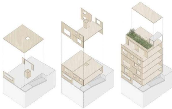
**Figura 12:** Isometría de las plantas del edificio
