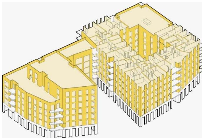
**Figura 25:** Dibujo de la estructura de CLT
