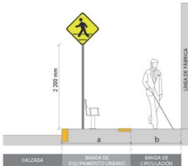
Ilustración 73. Banda de Equipamiento Urbano. Fuente: NTE INEN 2314
