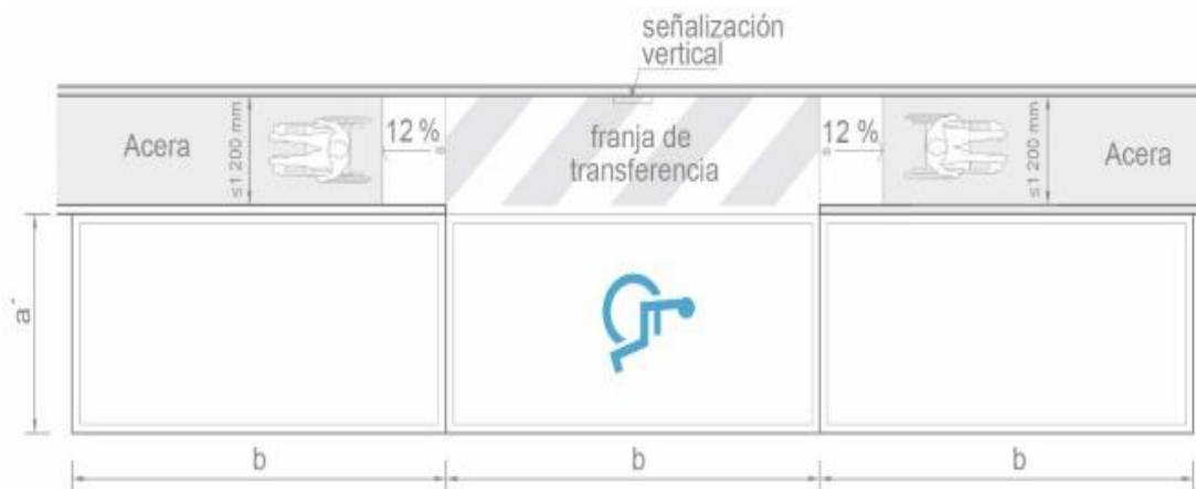
Ilustración 87. Altura de la acera rebajada hasta el nivel de la vía pública.
