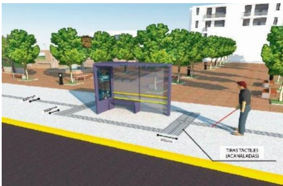
Ilustración 66. Franjas táctiles acanaladas en aceras para personas con limitaciones visuales. Fuente: NTE INEN 2243
