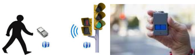
Ilustración 125. Semáforo accesible para invidentes que detecta al usuario. Elaborado por: (Chao & Mosquera, 2022).
