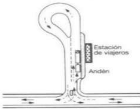
6 Pequeña estación con rotonda para cambiar de sentido
