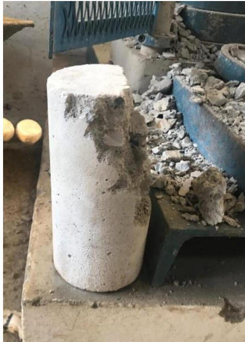
Figura 15: Rotura a los 7 días.
