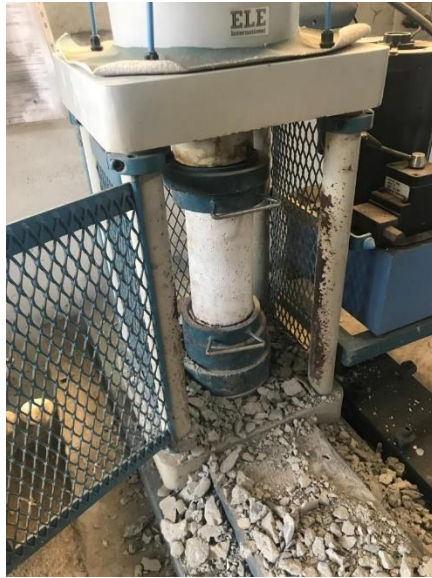
Figura 8: Resistencia a la compresión.
