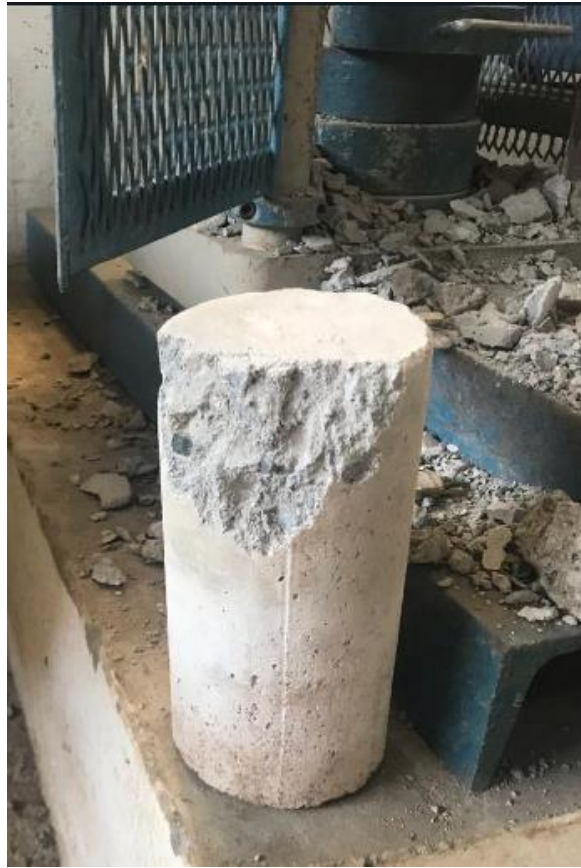
Figura 16: Rotura a los 28 días.
