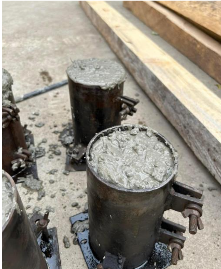
Figura 12: Toma de cilindros de hormigón.
