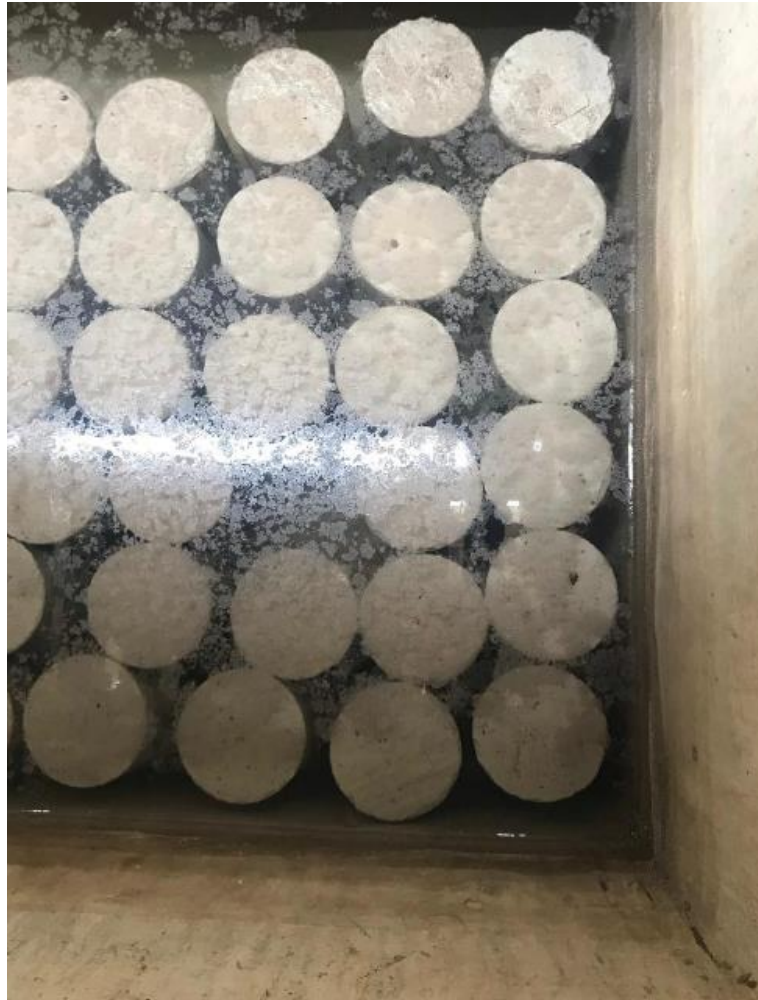
Figura 13: Curado de cilindros de hormigón.
