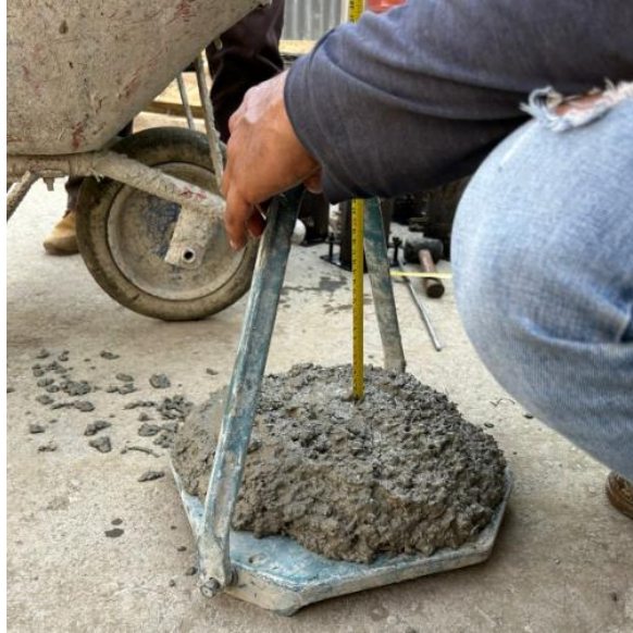
Figura 14: Toma de revenimiento
