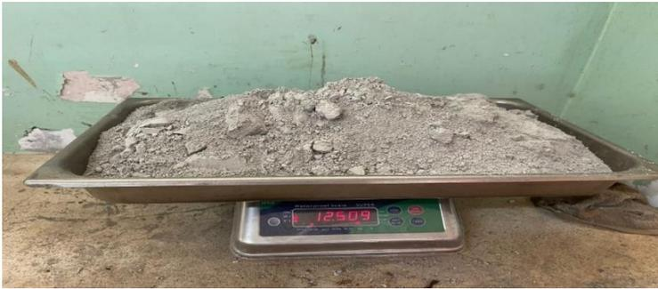
**Figura 9:** Dosificación de cemento para especímenes de hormigón
