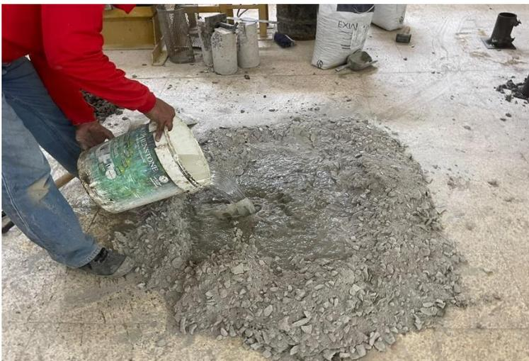
**Figura 10:** Preparación de hormigón para especímenes de hormigón
