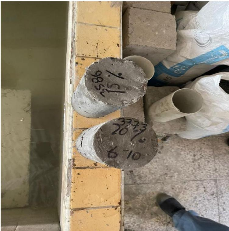
**Figura 20:** Muestra de cilindros del 10% y 15% de agregado de Concha de Coco
