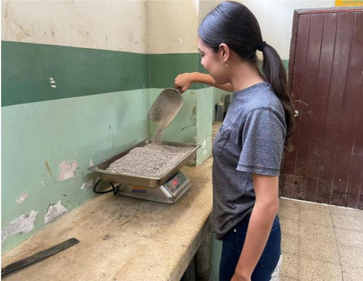
**Figura 7:** Dosificación de agregado fino (arena) para elaboración de especímenes de hormigón para ensayo
