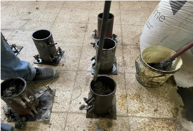
**Figura 11:** Preparación y colocación de hormigón para especímenes de hormigón y compactando 25 hincadas con una varilla de acero lisa.
