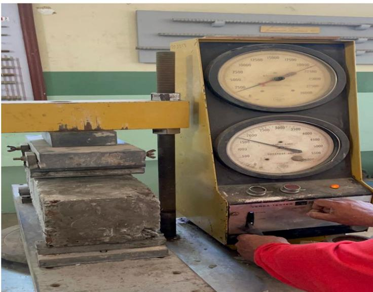
**Figura 26:** Ensayo para determinar la resistencia a la flexión.
