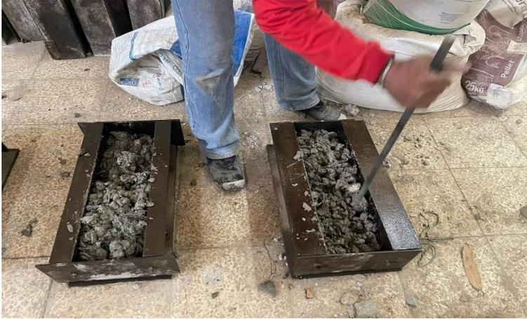
**Figura 13:** Colocación de hormigón en moldes de vigas.
