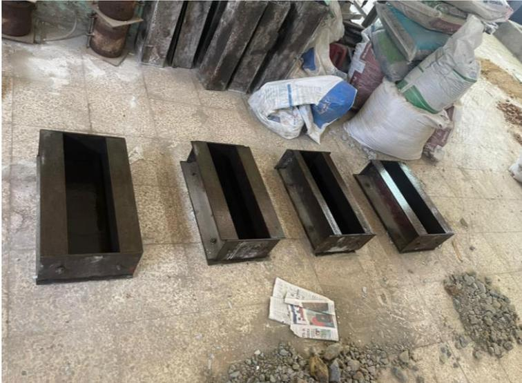
**Figura 6:** Modelos de molde de vigas para pruebas de ensayo de concreto.
