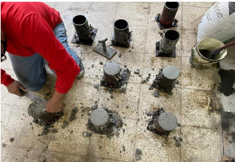
**Figura 12:** Preparación y colocación de hormigón para especímenes de hormigón.
