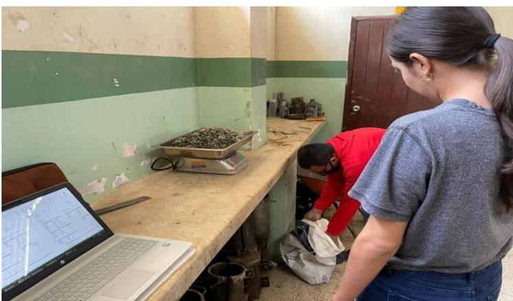
**Figura 16:** Dosificación de agregado grueso (piedra triturada 3/4") para bloque de hormigón con adición de concha de coco
