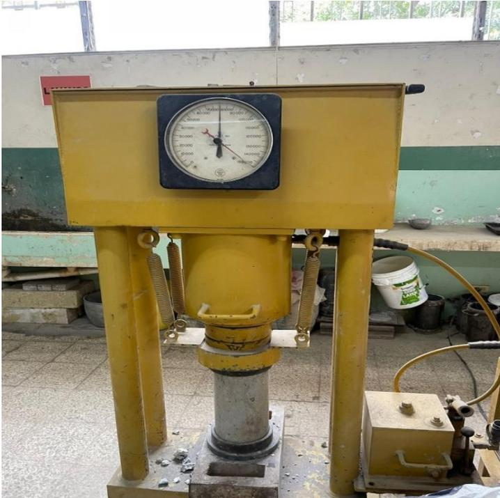
**Figura 22:** Ensayo de compresión a probeta con adición de concha de coco al 15%
