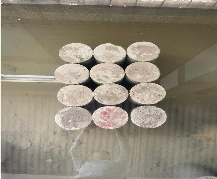
**Figura 14:** Muestras sumergidas en agua para curado.
