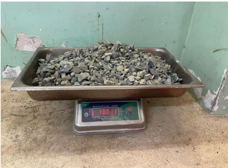
**Figura 8:** Dosificación de agregado grueso (piedra triturada  $\frac{3}{4}$ '' ) para especímenes de hormigón para ensayo
