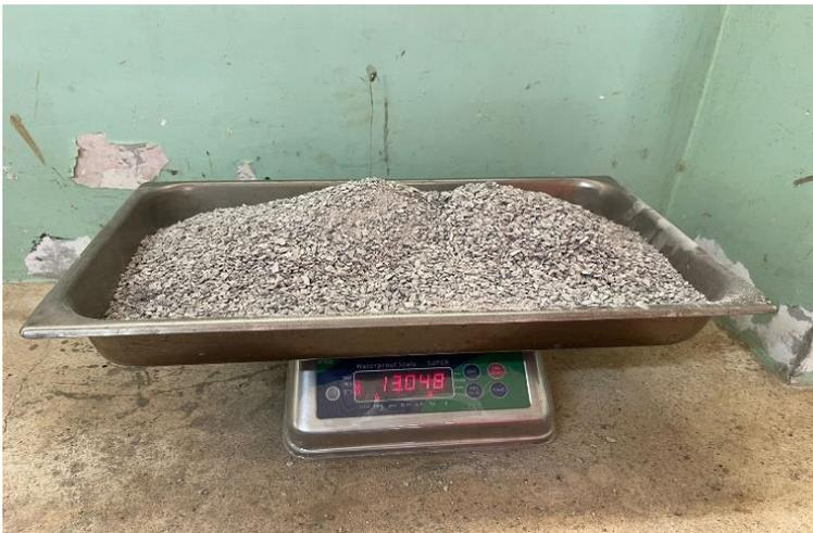
**Figura 15:** Dosificación de agregado fino (arena) para probetas de hormigón con adición de concha de coco
