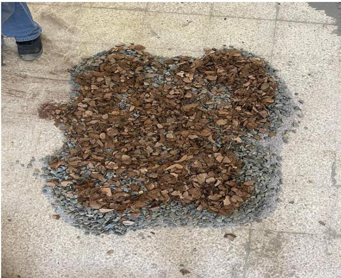
**Figura 18:** Mezcla de agregado fino, agregado grueso y concha de coco triturada.
