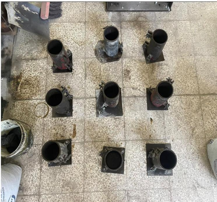
**Figura 5:** Modelos de molde de cilindros de 0.15x0.30cm con placa de asiento con un ángulo de 90°
