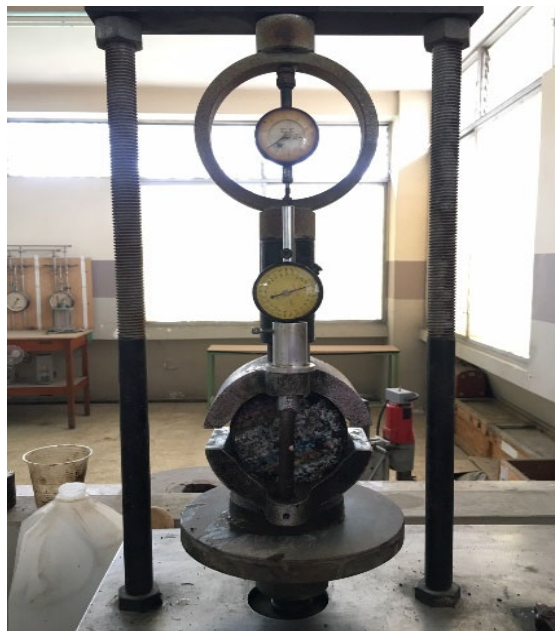
Figura 8. Ensayo de tracción. Espinoza & Navarrete (2023)
