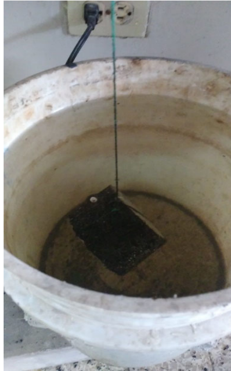
Figura 28. Peso de la briqueta sumergida en el agua. Elaborado por: Espinoza & Navarrete (2023)
