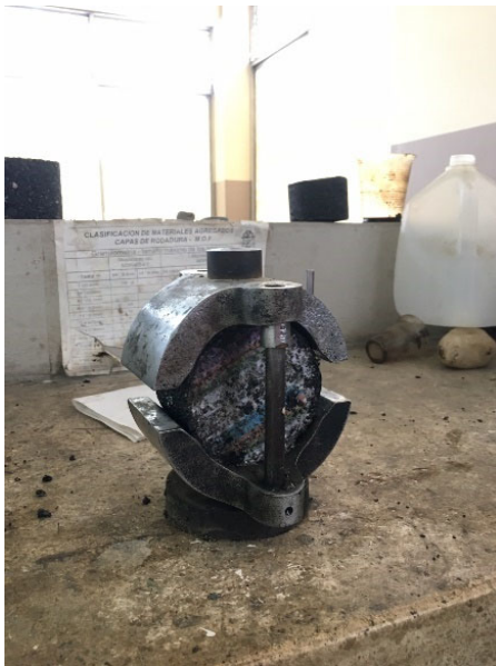
Figura 32. Briqueta en la probeta Marshall. Elaborado por: Espinoza & Navarrete (2023)
