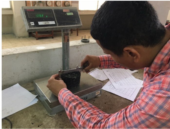
Figura 26. Medición de la briqueta. Elaborado por: Espinoza & Navarrete (2023)
