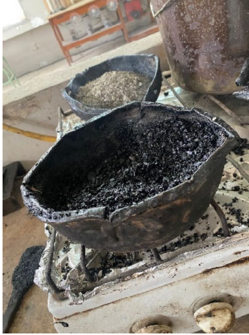
Figura 20. Calentamiento de agregados y asfalto. Elaborado por: Espinoza & Navarrete (2023)
