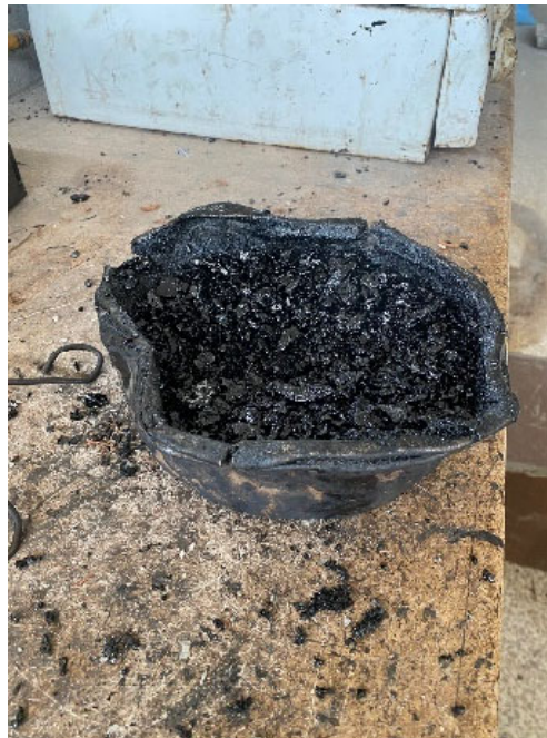
Figura 19. Mezcla de agregado, asfalto y caucho. Elaborado por: Espinoza & Navarrete (2023)
