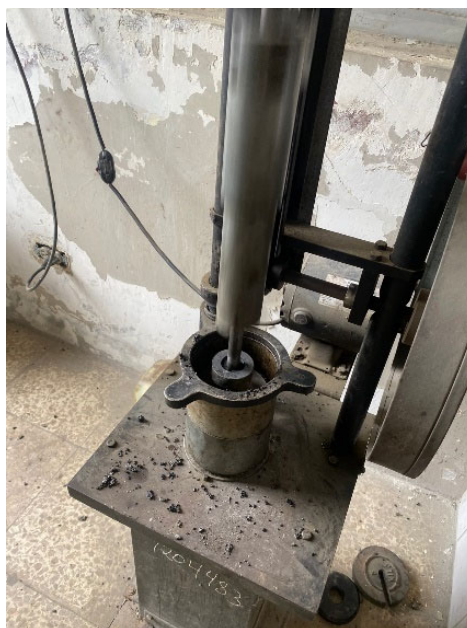
Figura 22. Compactación de la mezcla asfáltica. Elaborado por: Espinoza & Navarrete (2023)
