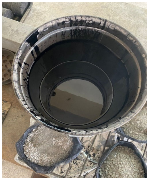
Figura 11. Calentamiento del cemento asfáltico. Elaborado por: Espinoza & Navarrete (2023)
