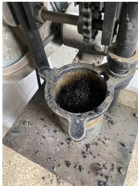
Figura 21. Proceso de compactación de la mezcla asfáltica. Elaborado por: Espinoza & Navarrete (2023)
