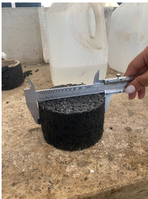
Figura 24. Medición de la briqueta. Elaborado por: Espinoza & Navarrete (2023)
