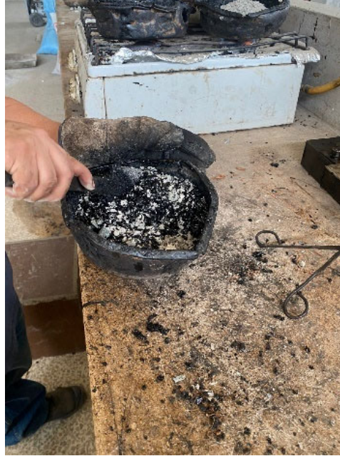
Figura 18. Mezcla de agregados, asfalto y caucho. Elaborado por: Espinoza & Navarrete (2023)
