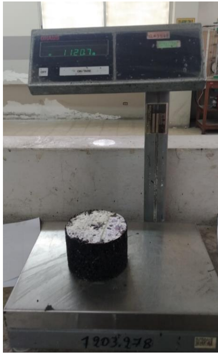
Figura 9 Toma de peso de briqueta
