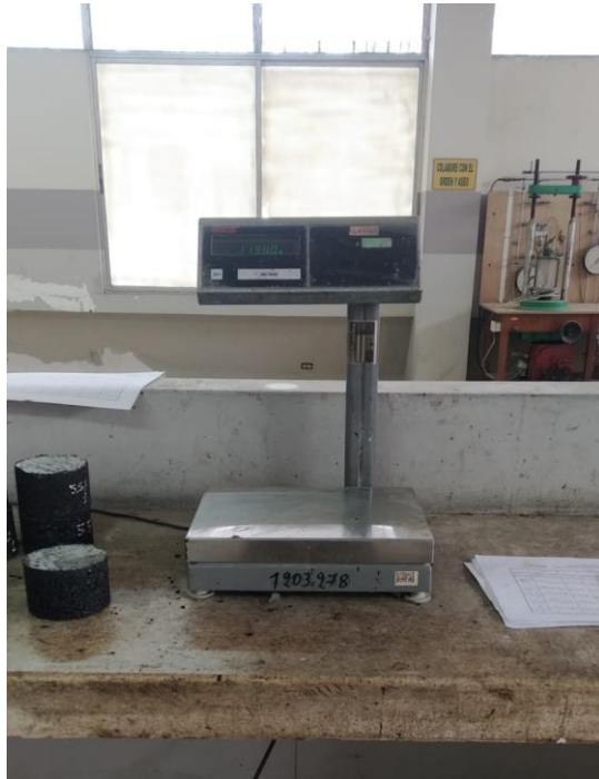
Figura 11 Toma de peso una vez tomado su peso saturado y secado en el horno
