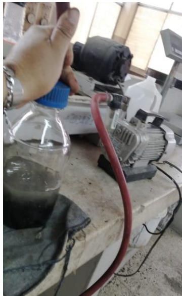
Figura 17 Frasco con muestra de asfalto y bomba de vacíos Elaborado: Carnero y Parrales (2023)
