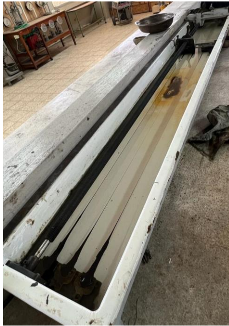
Figura 15 Estiramiento de las muestras de asfalto
