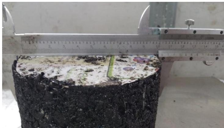
Figura 9 Toma de dimensiones de briqueta
