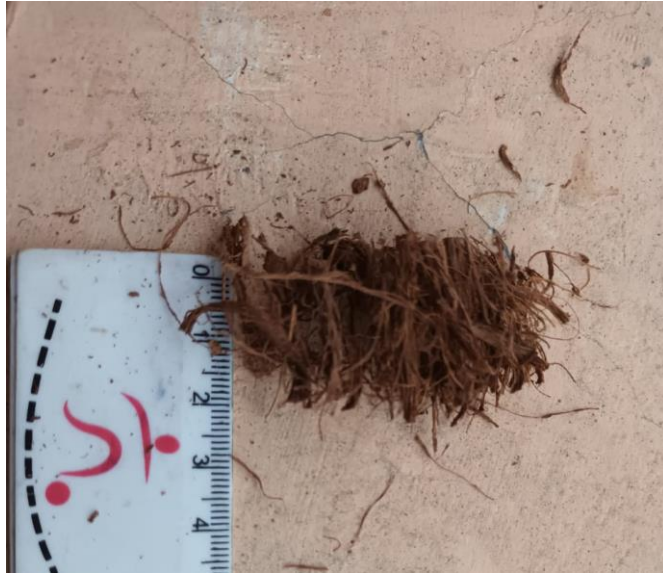
Figura 3 Obtención de la fibra de coco
