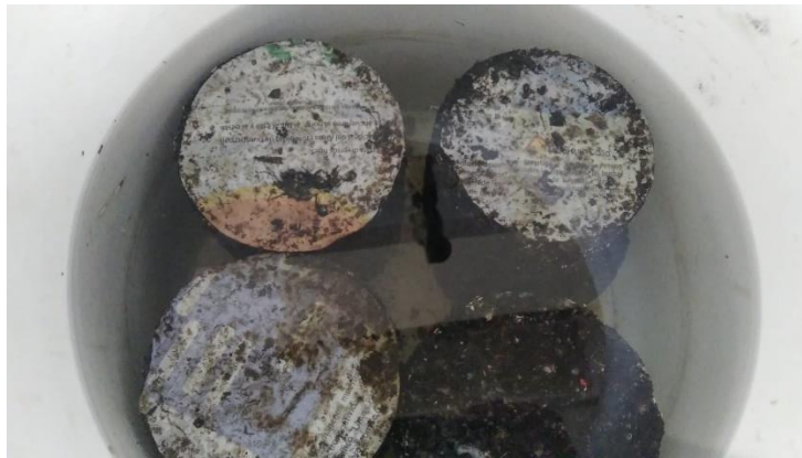
Figura 10 Saturado de briquetas
