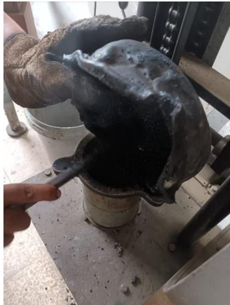
Figura 6 Vertido de mezcla en molde cilíndrico
