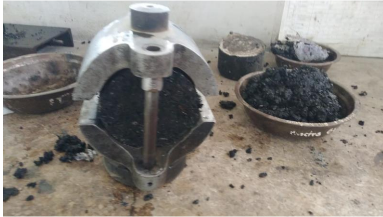
Figura 13 Colocación de briqueta en la máquina para el ensayo Elaborado: Carnero y Parrales (2023)
