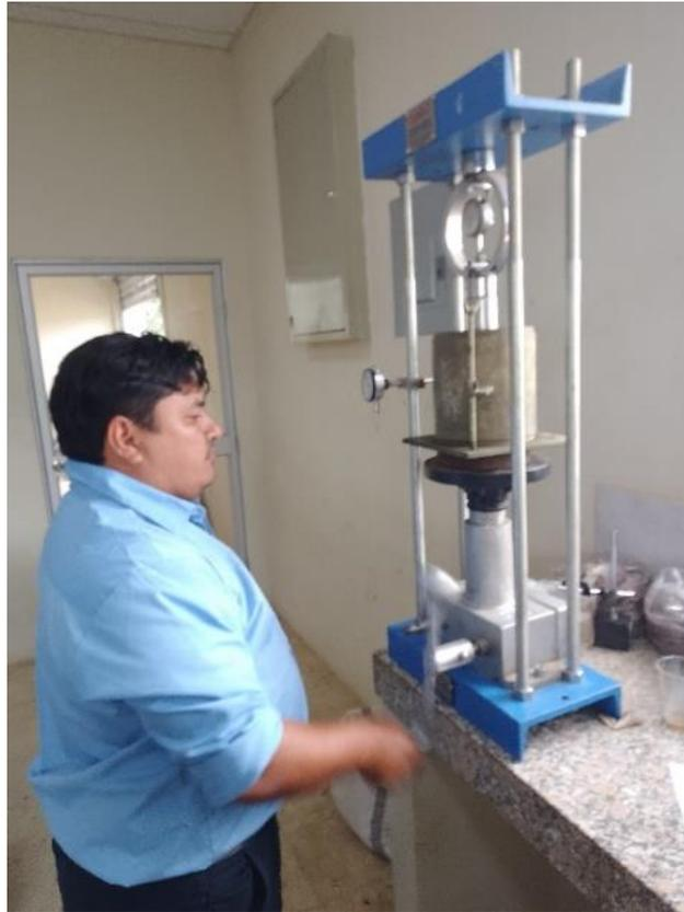
**Foto 12:** Ensayo C.B.R. penetración
