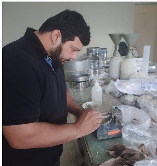
**Foto 7:** Ensayo de limite liquido
