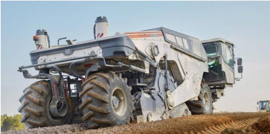
**Figura 1:** Maquina mezcladora de base estabilizada
