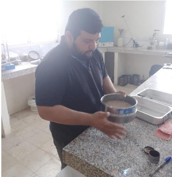
**Foto 8:** Ensayo granulométrico
