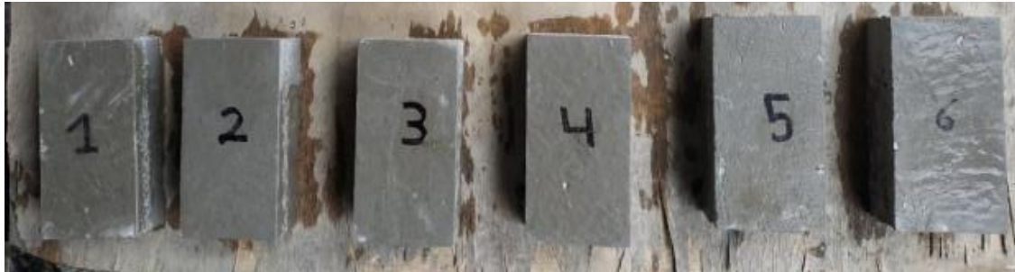
Ilustración 12: Adoquín rectangular a base de papel y cartón reciclado Fuente: Peña, A. y Gary Peña, G. (2022)
