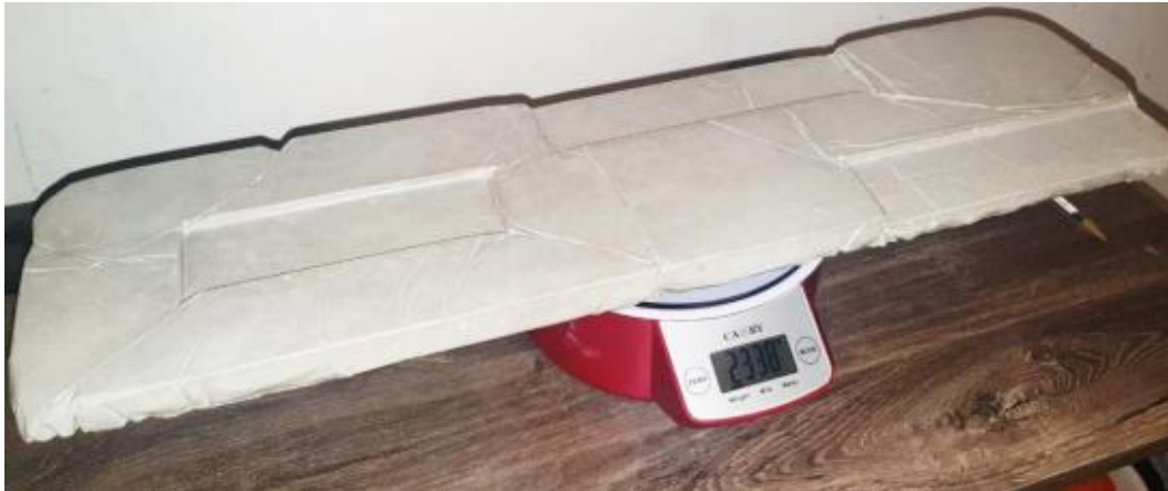
Ilustración 8: Fachaleta de mortero con poliestireno expandido Fuente: Yagual, C (2021)
