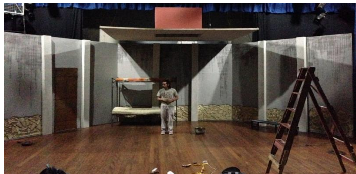
Ilustración 40: Escenografía realizada en un 80 por ciento con cartón corrugado y poliestireno expandido. Fuente: Fonseca, A. (2015)
