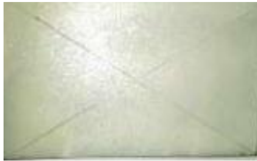
Ilustración 10: Recubrimiento anticorrosivo a base de poliestireno reciclado Fuente: Cárdenas, T (2018)
