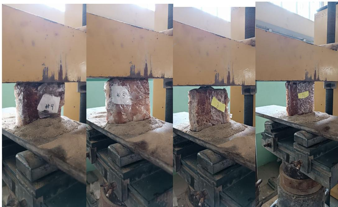
**Figura 16.** Ensayo a la compresión
