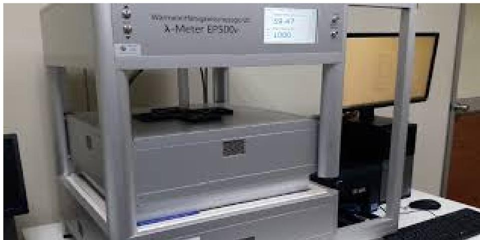
**Figura 14.** Equipo de ensayo de conductividad térmica
