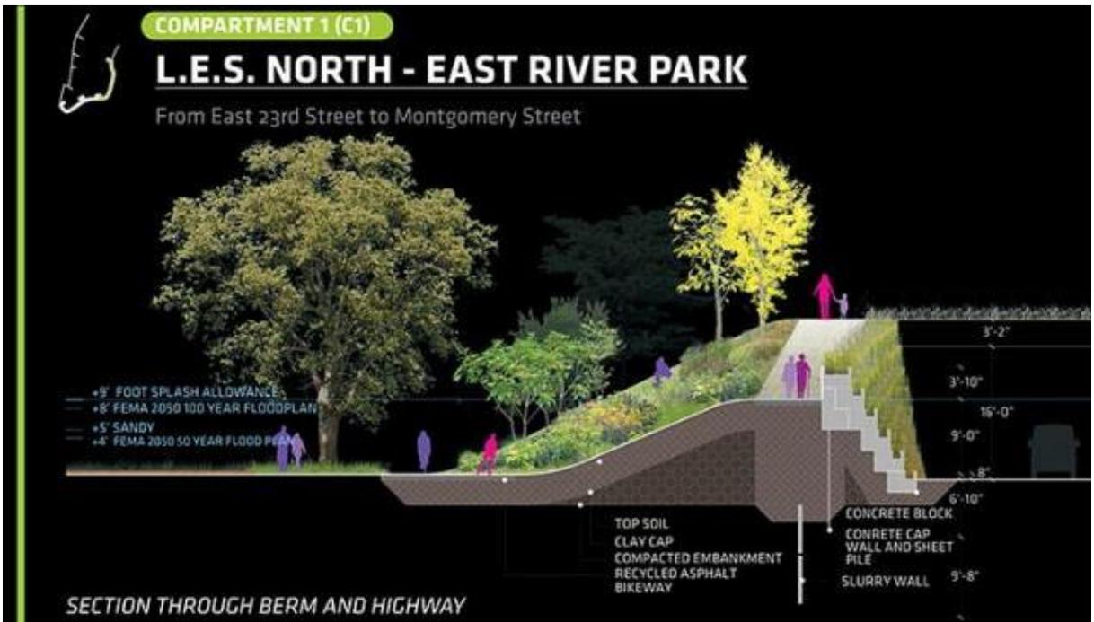
**Figura 16.** Sección de talud del Dryline
